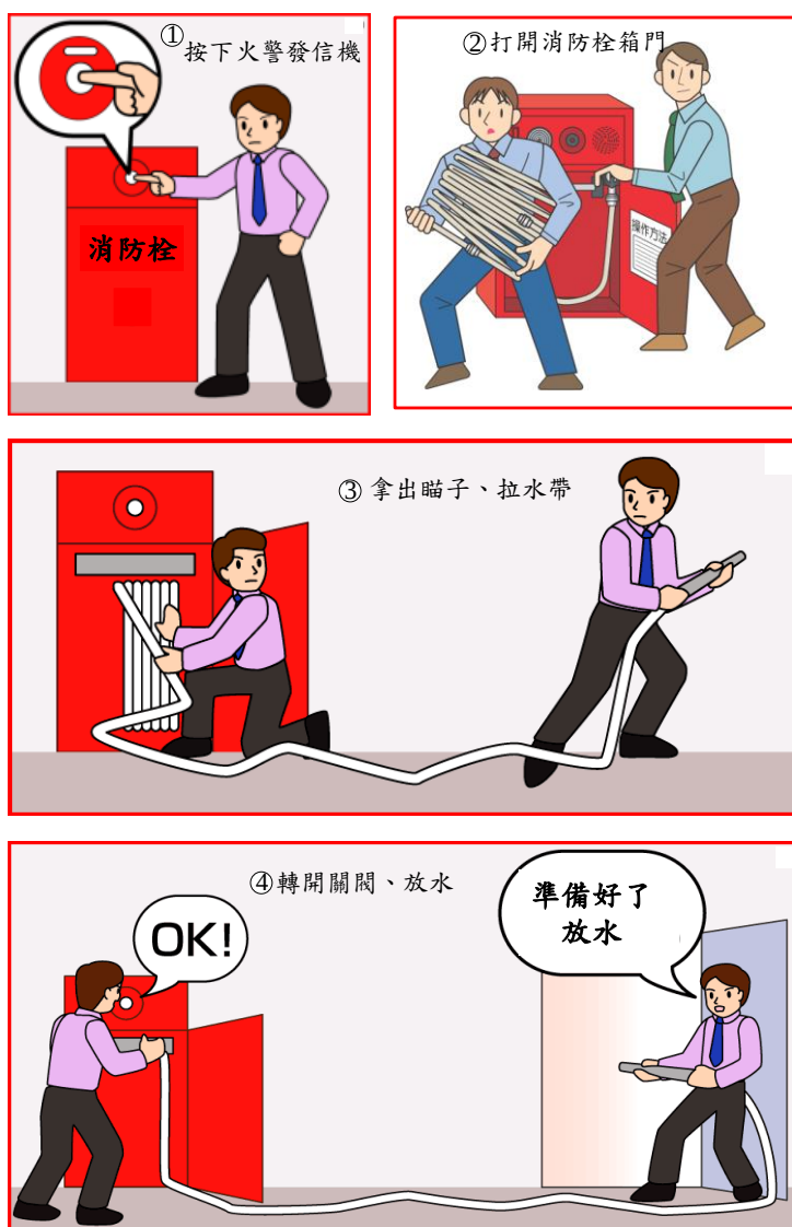
圖 3-38 第1種室內消防栓操作方法 (資料來源：消防署防火管理人講習訓練教材)
