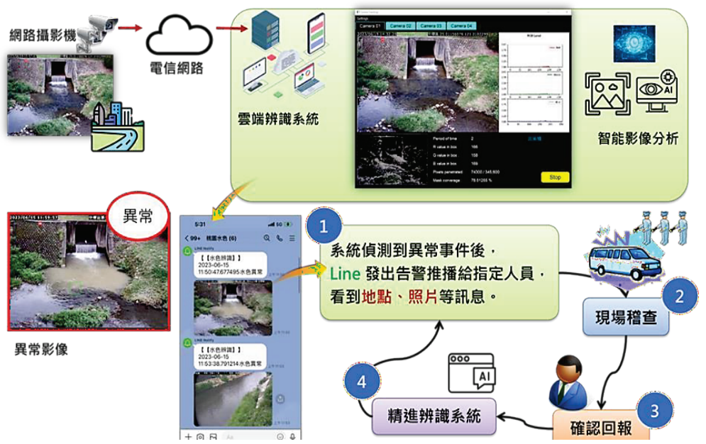
圖 9 112 年度 AI 水色辨識流程及系統建置場域
