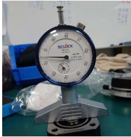
薄膜節流器節流深度量測
