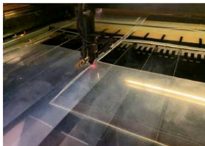
雷射切割各式抗藍光螢幕尺寸薄膜
