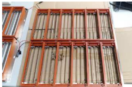
多組電漿模組串聯，增加使用面積
