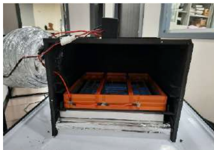
電漿模組運用： 放入風箱，配合室內循環清淨空氣
