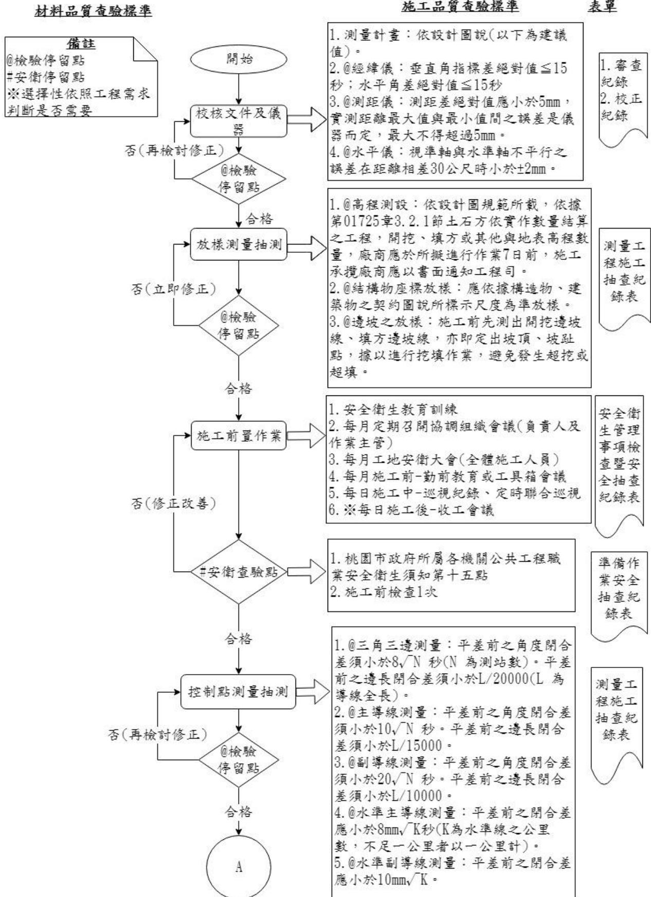
圖 017250-F-1 測量工程施工抽查流程圖 1/2
