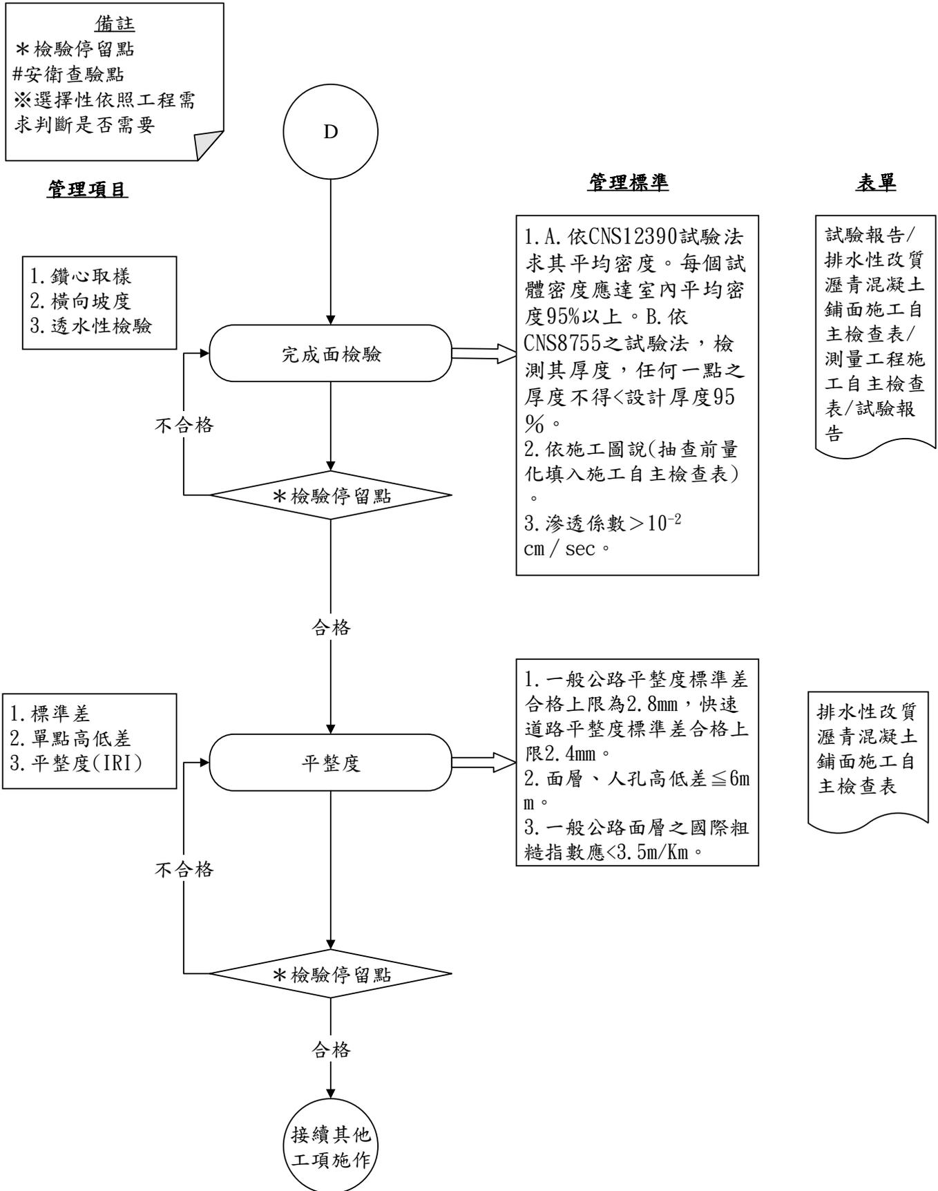
圖 027971-QCF-1 排水性改質瀝青混凝土鋪面施工檢驗流程圖 5/5
