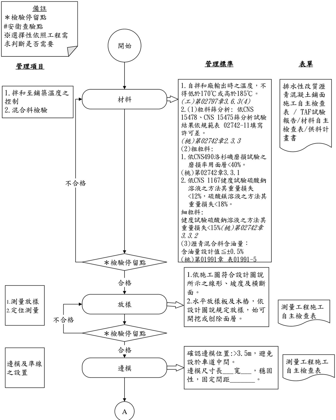
圖 027971-QCF-1 排水性改質瀝青混凝土鋪面施工檢驗流程圖 1/5
