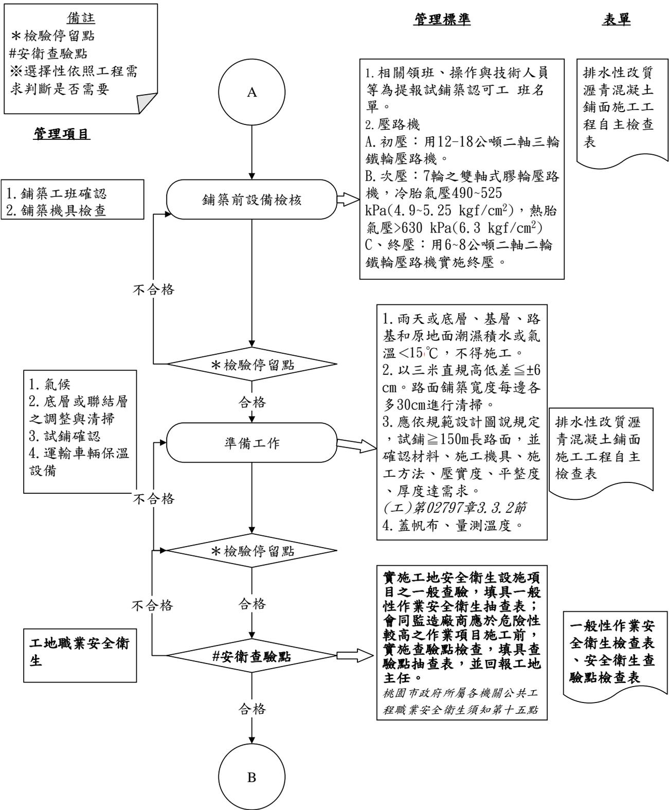
圖 027971-QCF-1 排水性改質瀝青混凝土鋪面施工檢驗流程圖 2/5
