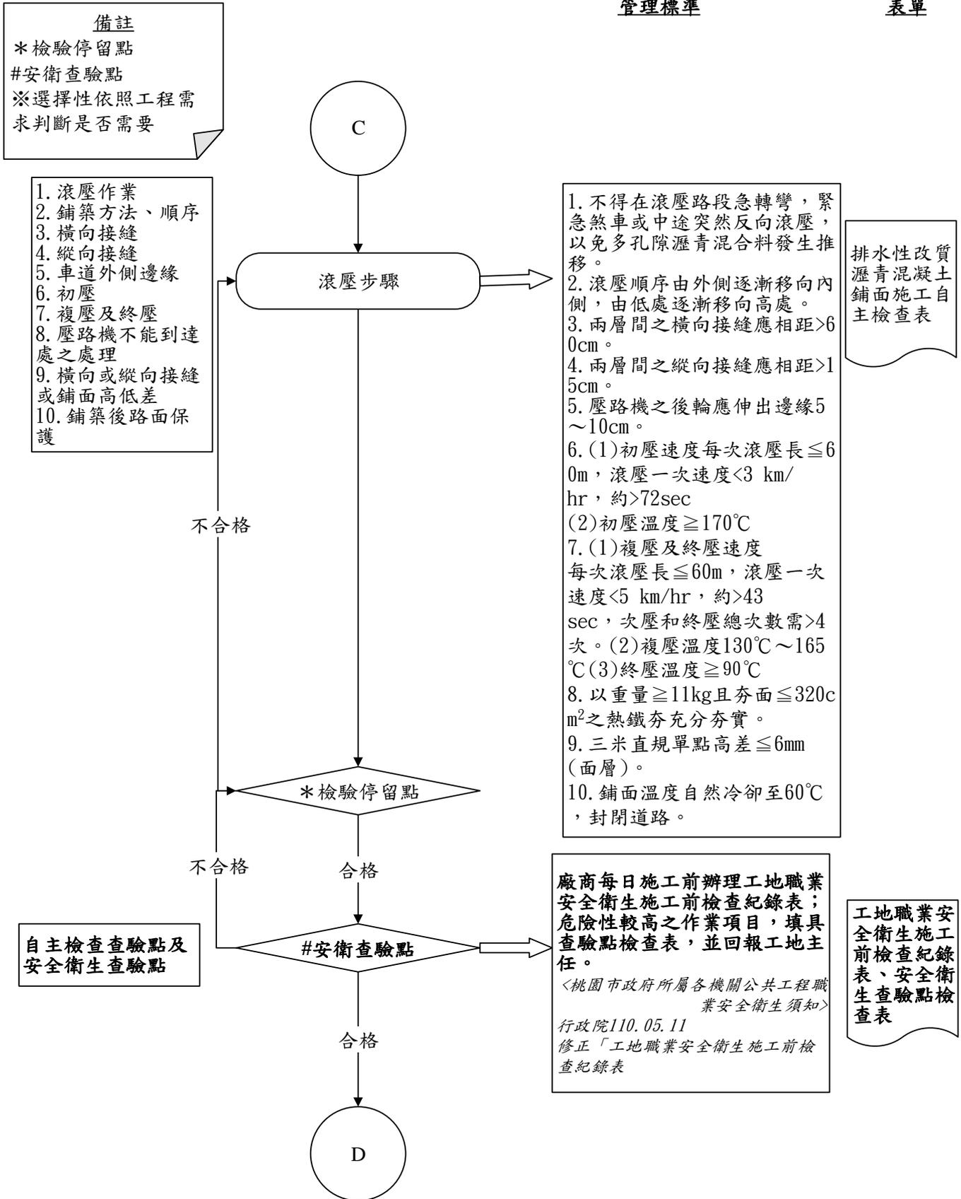
圖 027971-QCF-1 排水性改質瀝青混凝土鋪面施工檢驗流程圖 4/5
