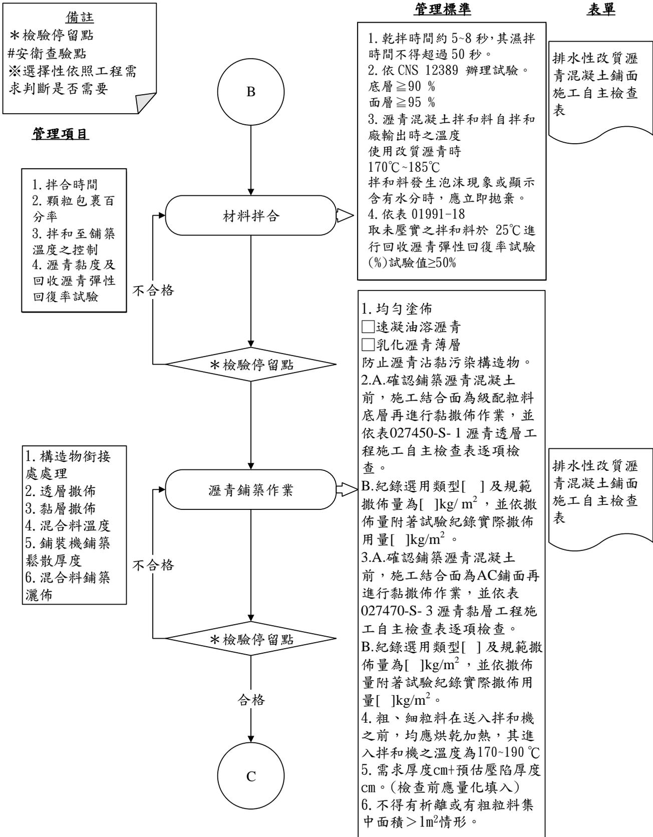
圖 027971-QCF-1 排水性改質瀝青混凝土鋪面施工檢驗流程圖 3/5
