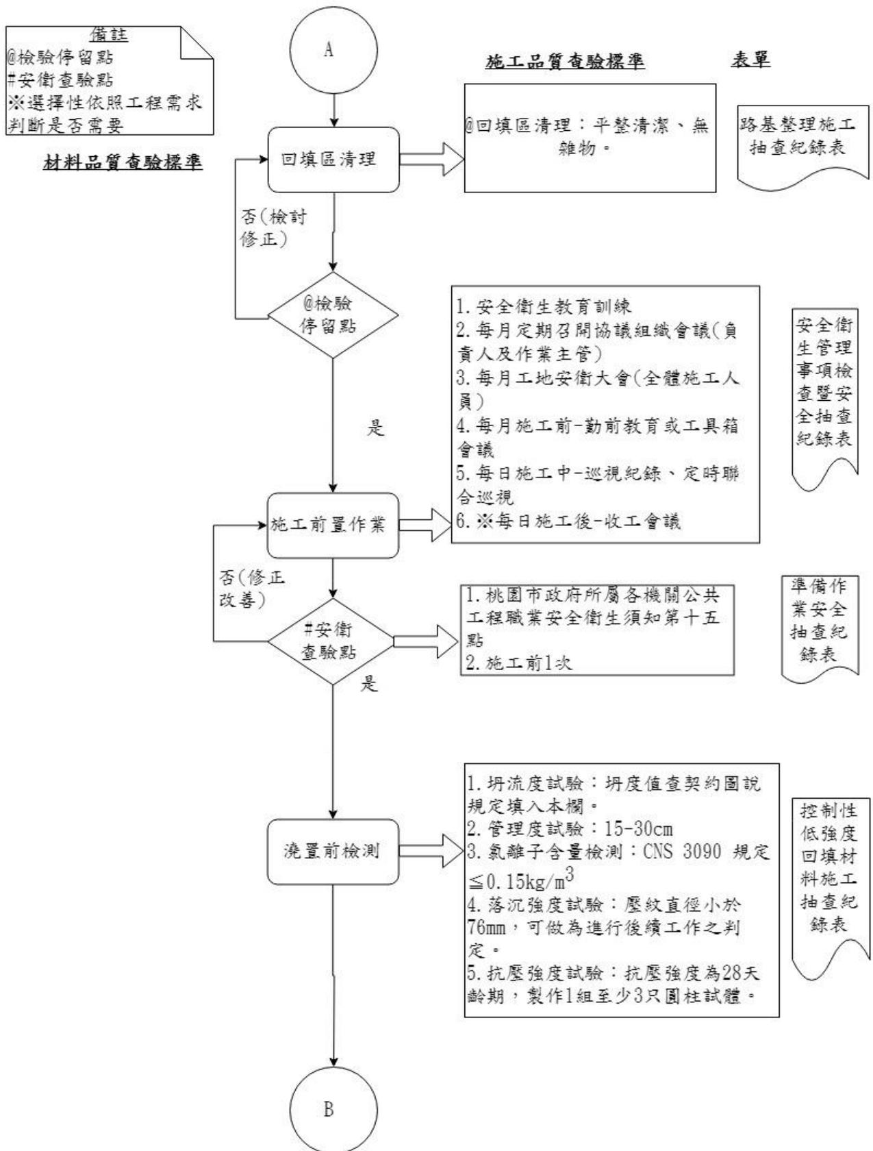
圖 033770-F-1 控制性低強度回填材料施工抽查流程圖 2/3
