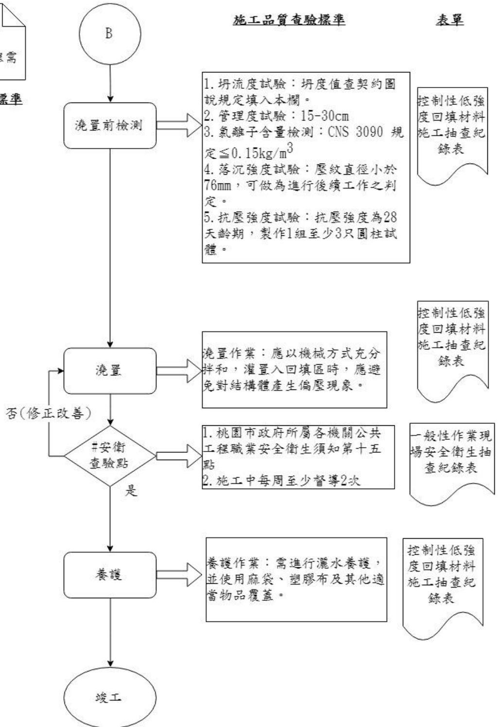
圖 033770-F-1 控制性低強度回填材料施工抽查流程圖 3/3
