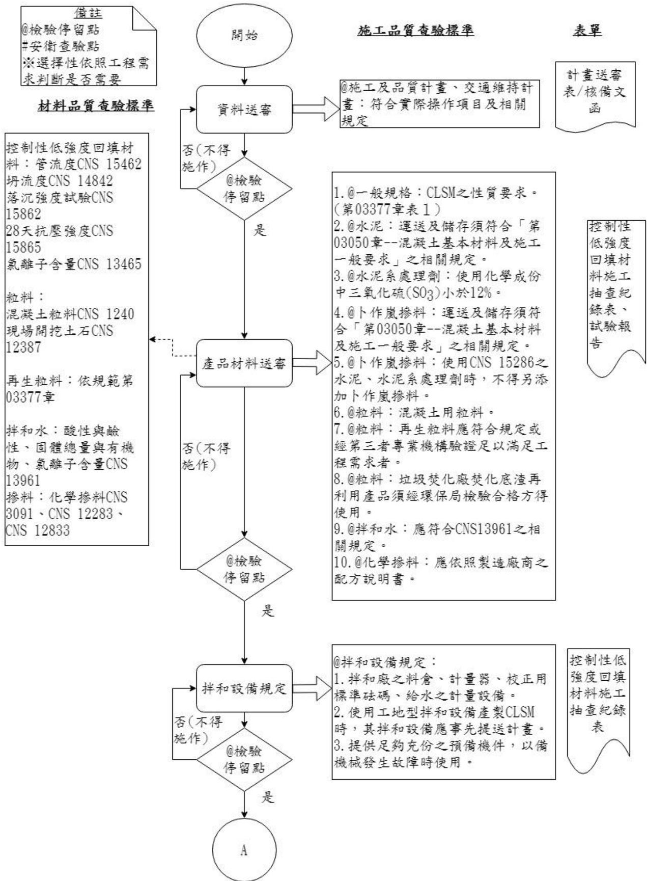
圖 033770-F-1 控制性低強度回填材料施工抽查流程圖 1/3
