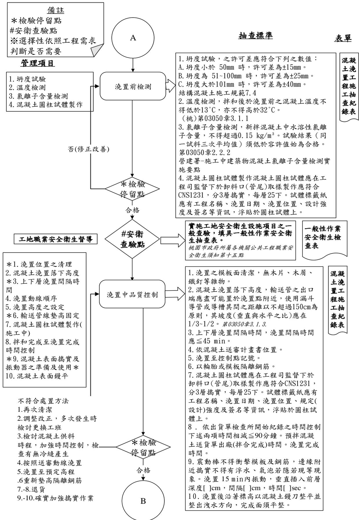
圖 030500-F-2 水泥混凝土工程施工流程圖 2/3
