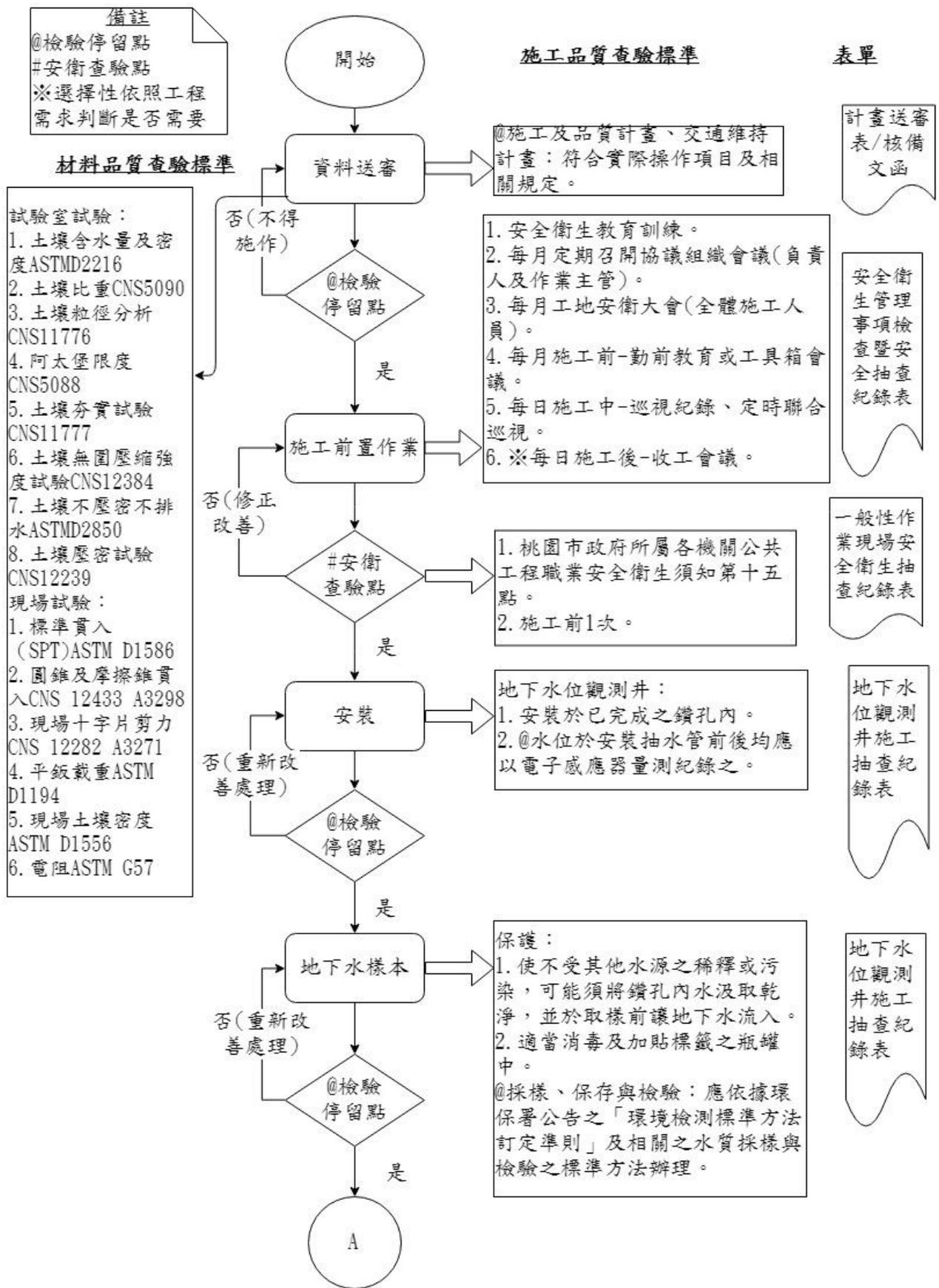
圖 022100-F-1 地下水位觀測井施工抽查流程圖 1/2
