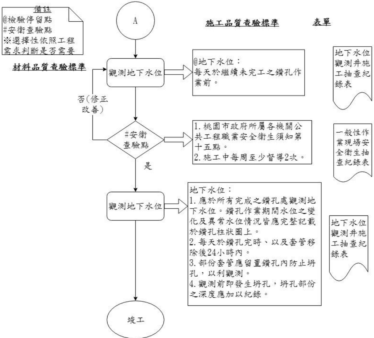
圖 022100-F-1 地下水位觀測井施工抽查流程圖 2/2
