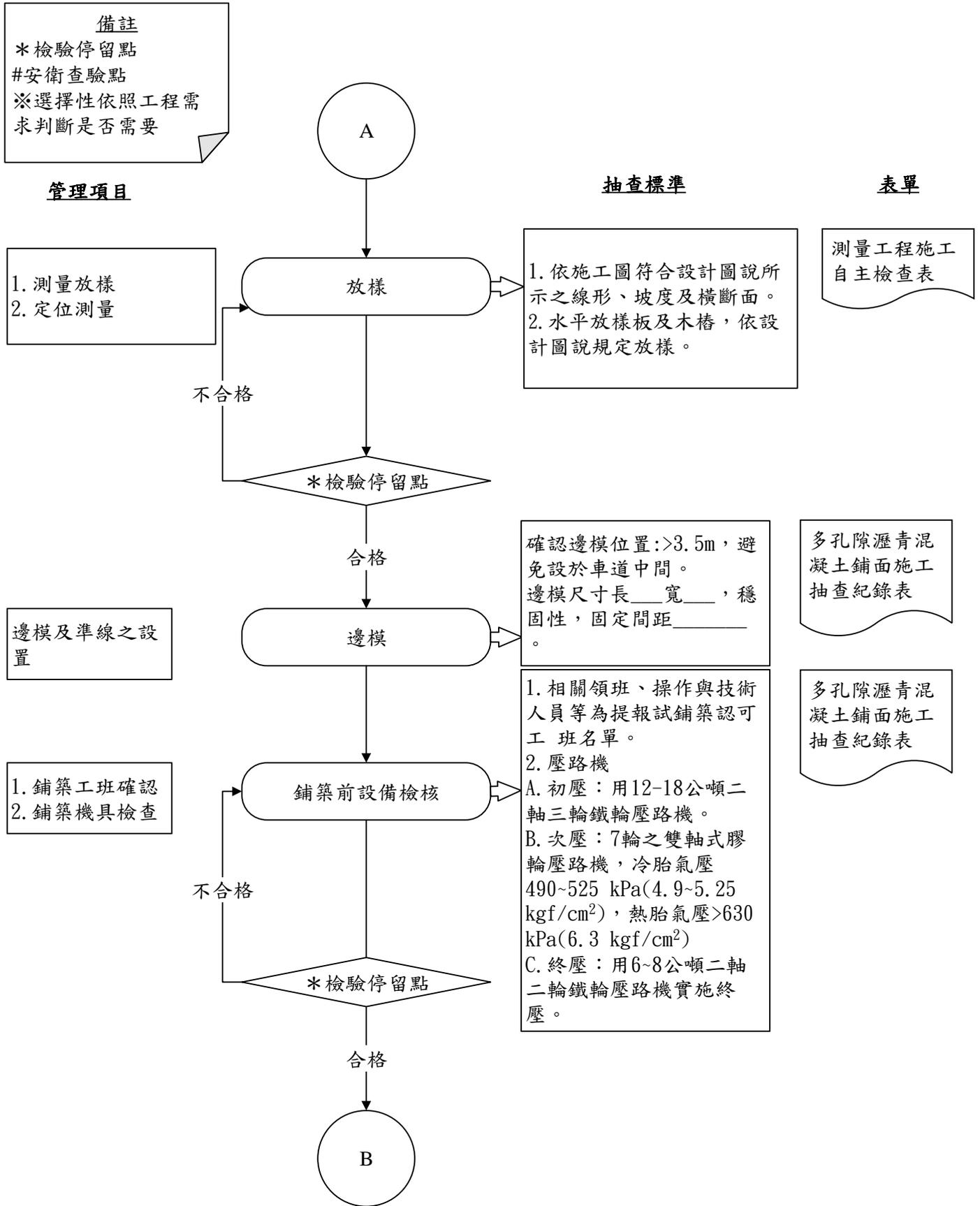
圖 027982-F-1 多孔隙瀝青混凝土鋪面工程施工抽查流程圖 2/6
