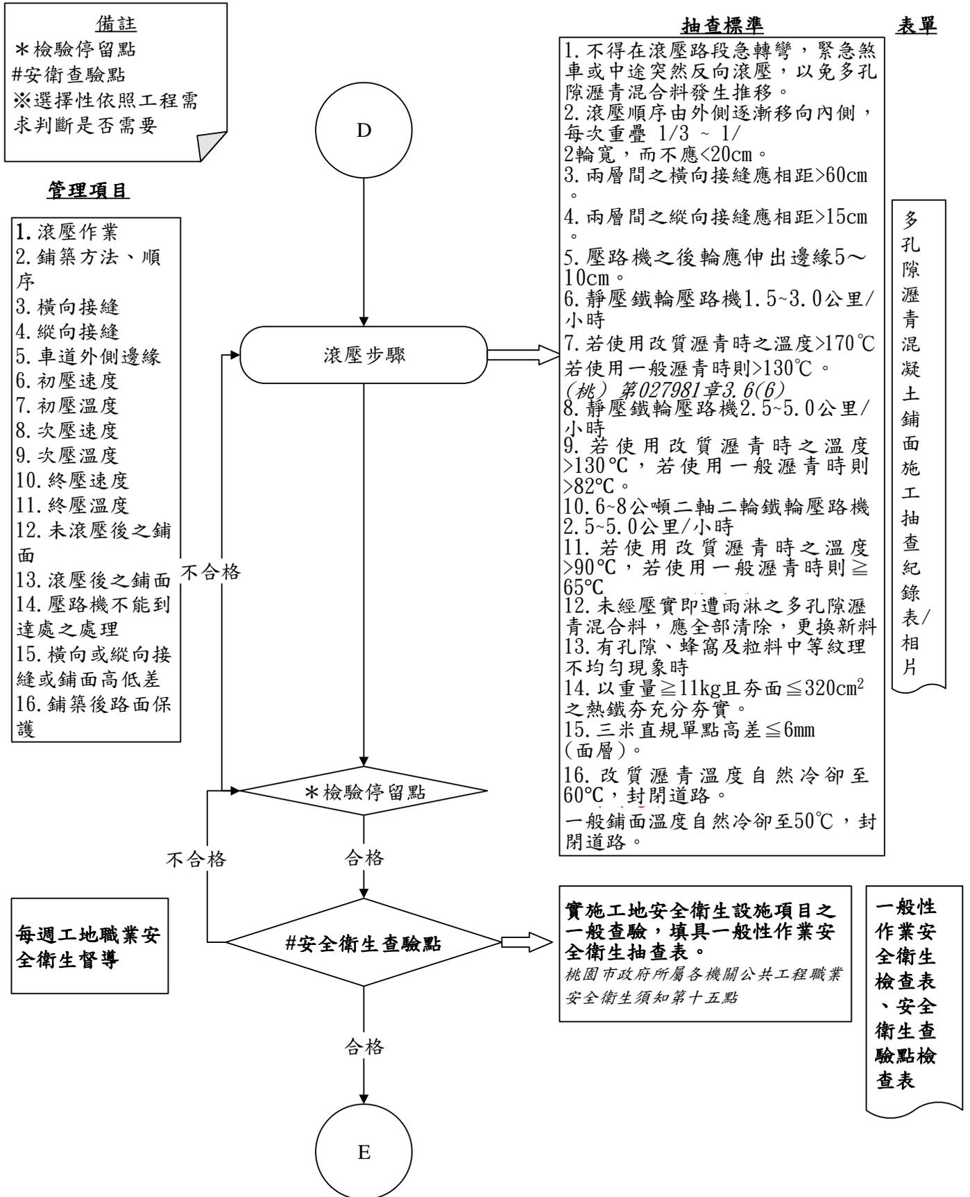
圖 027982-F-1 多孔隙瀝青混凝土鋪面工程施工抽查流程圖 5/6
