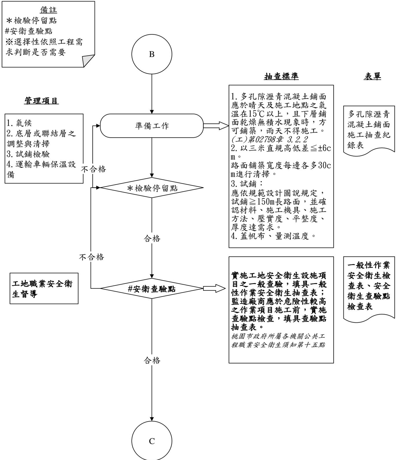
圖 027982-F-1 多孔隙瀝青混凝土鋪面工程施工抽查流程圖 3/6
