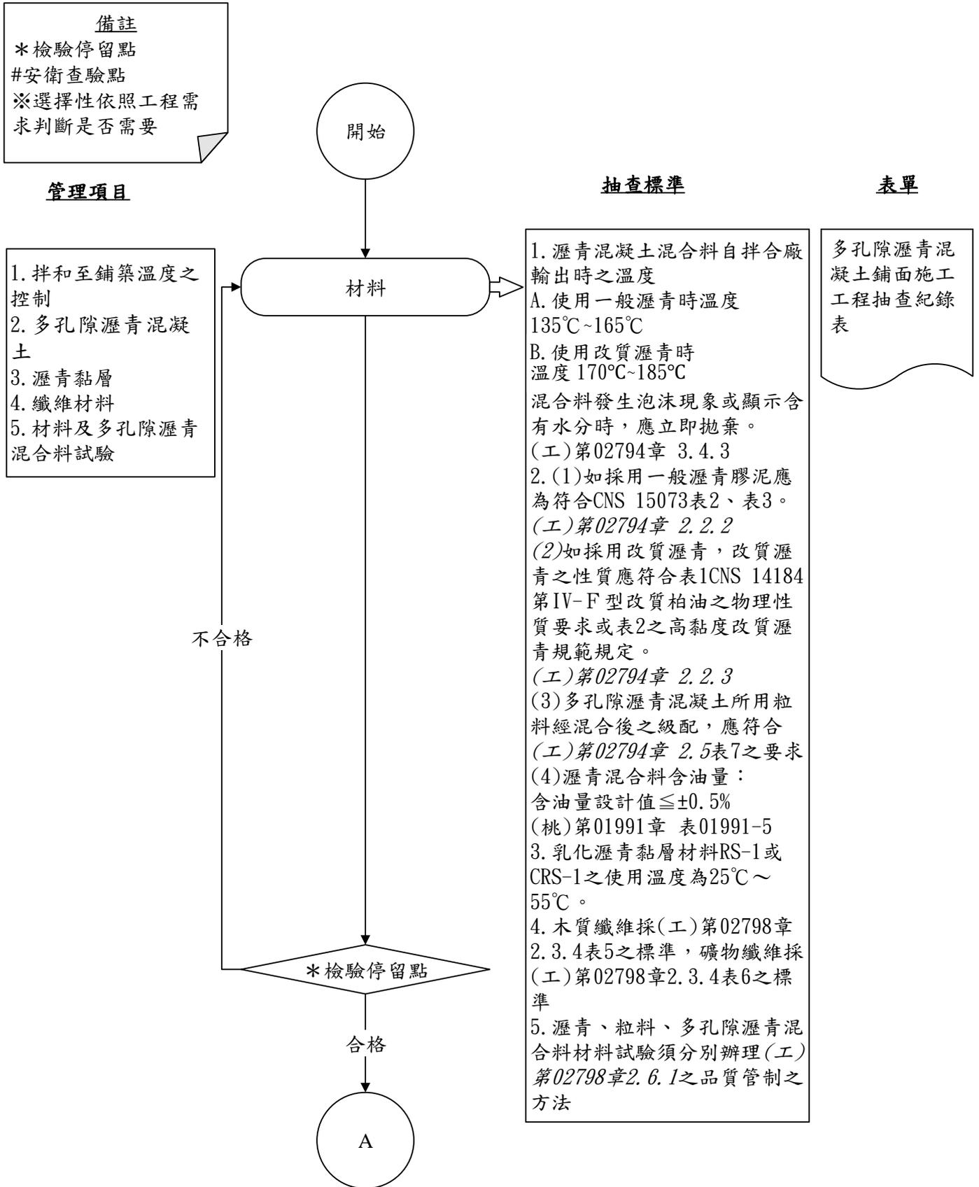
圖 027982-F-1 多孔隙瀝青混凝土鋪面工程施工抽查流程圖 1/6
