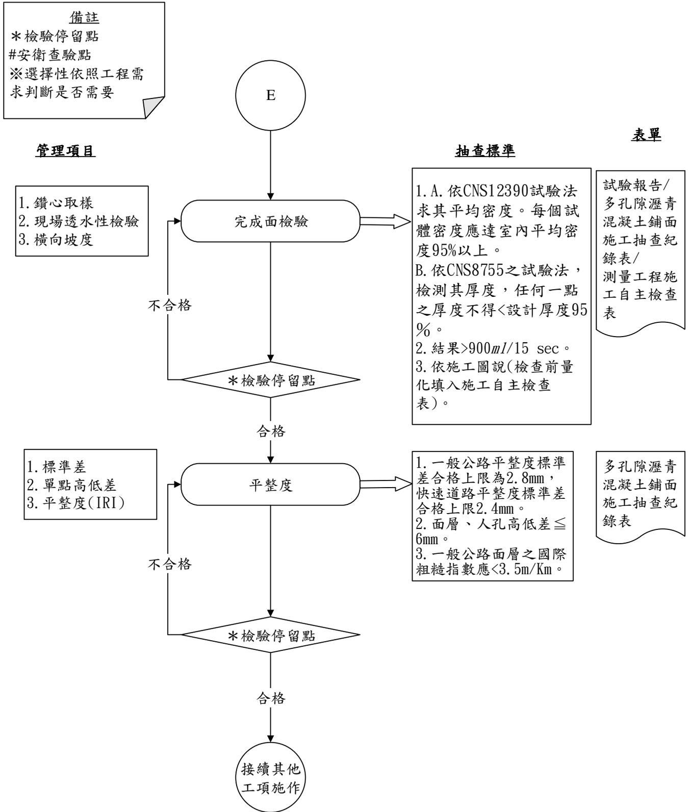
圖 027982-F-1 多孔隙瀝青混凝土鋪面工程施工抽查流程圖 6/6
