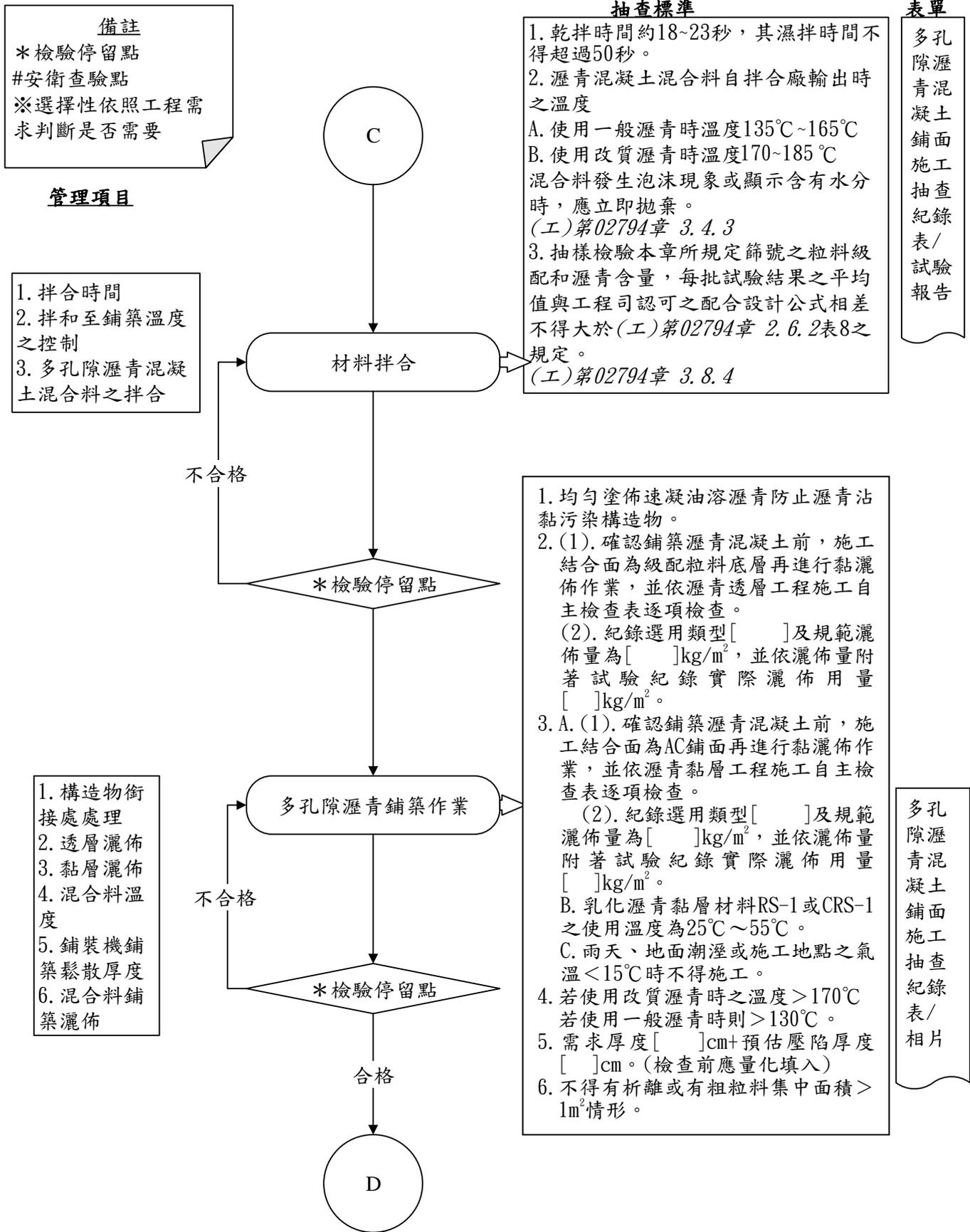
圖 027982-F-1 多孔隙瀝青混凝土鋪面工程施工抽查流程圖 4/6
