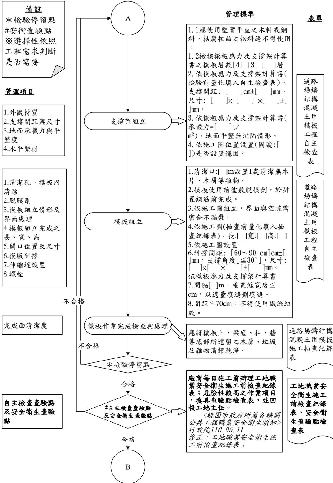
圖 031101-QCF- 2 道路場鑄結構混凝土用模板工程施工檢驗流程圖 2/3
