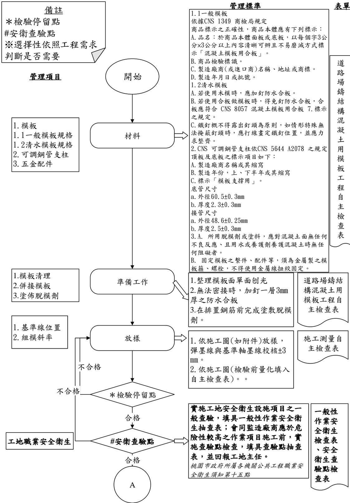
圖 031101-QCF- 1 道路場鑄結構混凝土用模板工程施工檢驗流程圖 1/3
