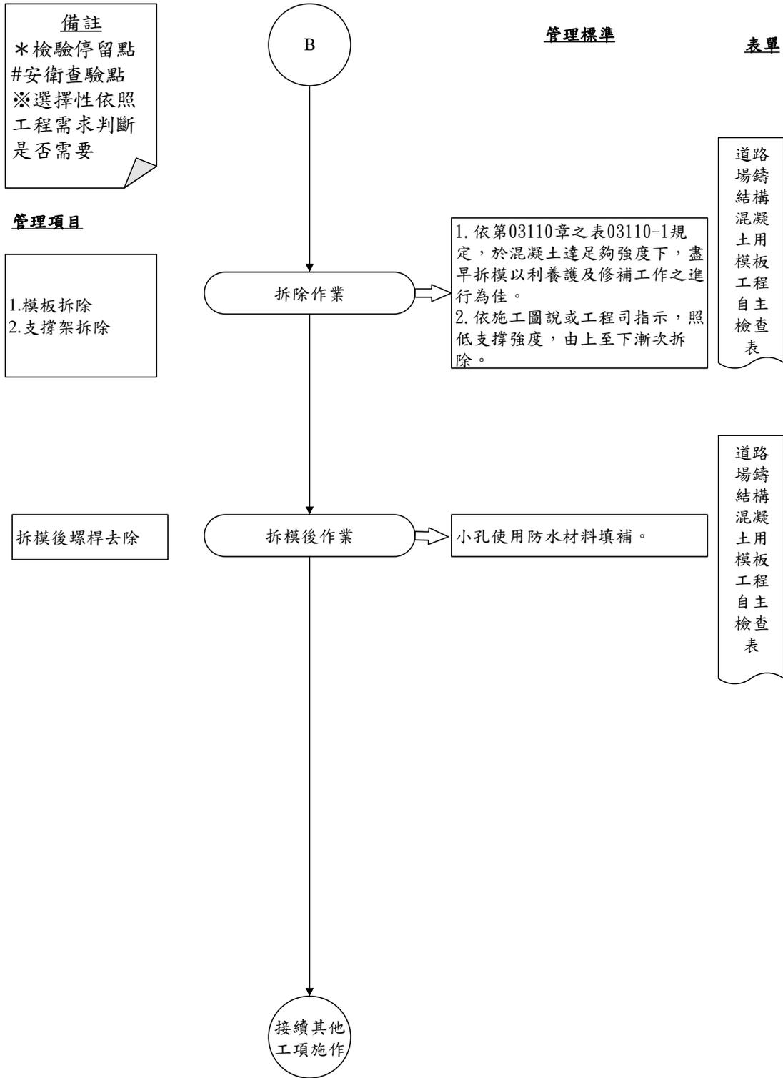
圖 031101-QCF- 3 道路場鑄結構混凝土用模板工程施工檢驗流程圖 3/3
