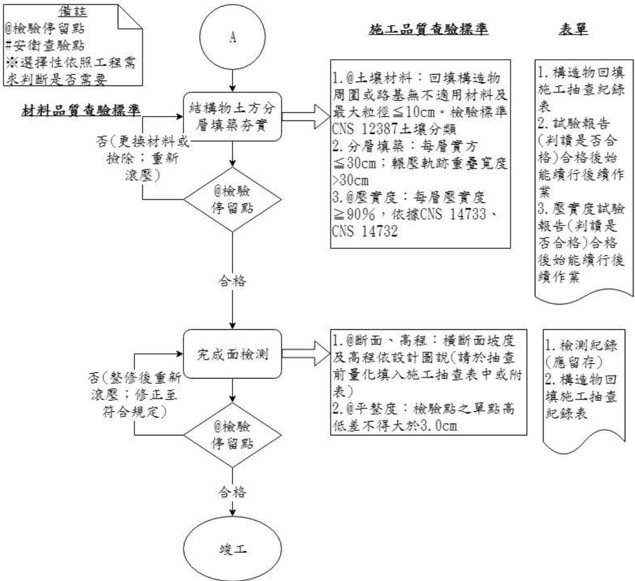
圖 023170-F-1 構造物回填施工抽查流程圖 2/2
