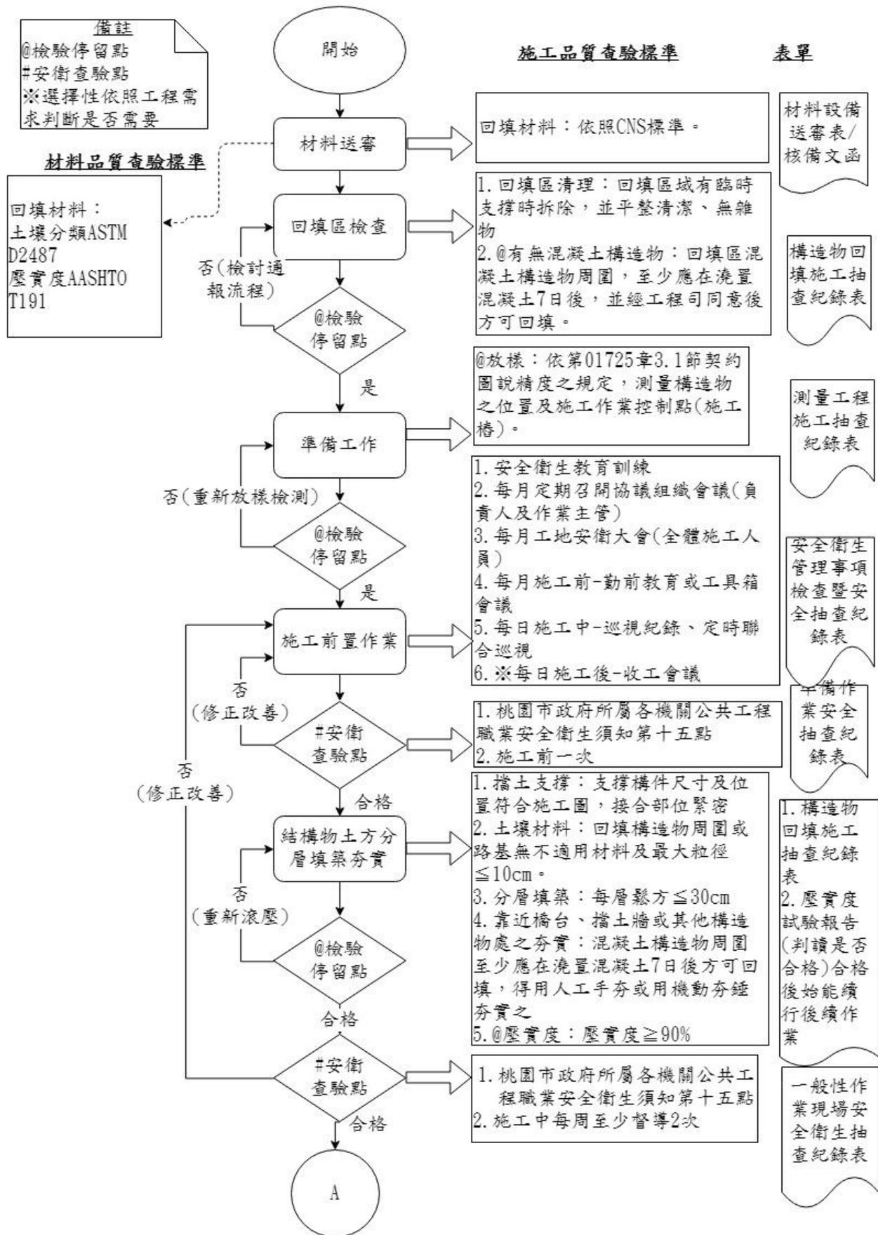
圖 023170-F-1 構造物回填施工抽查流程圖 1/2
