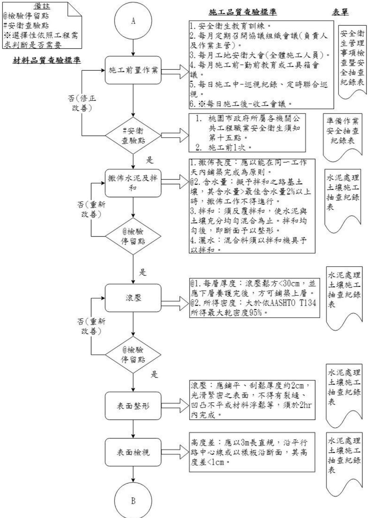
圖 027150-F-1 水泥處理土壤施工抽查流程圖 2/3
