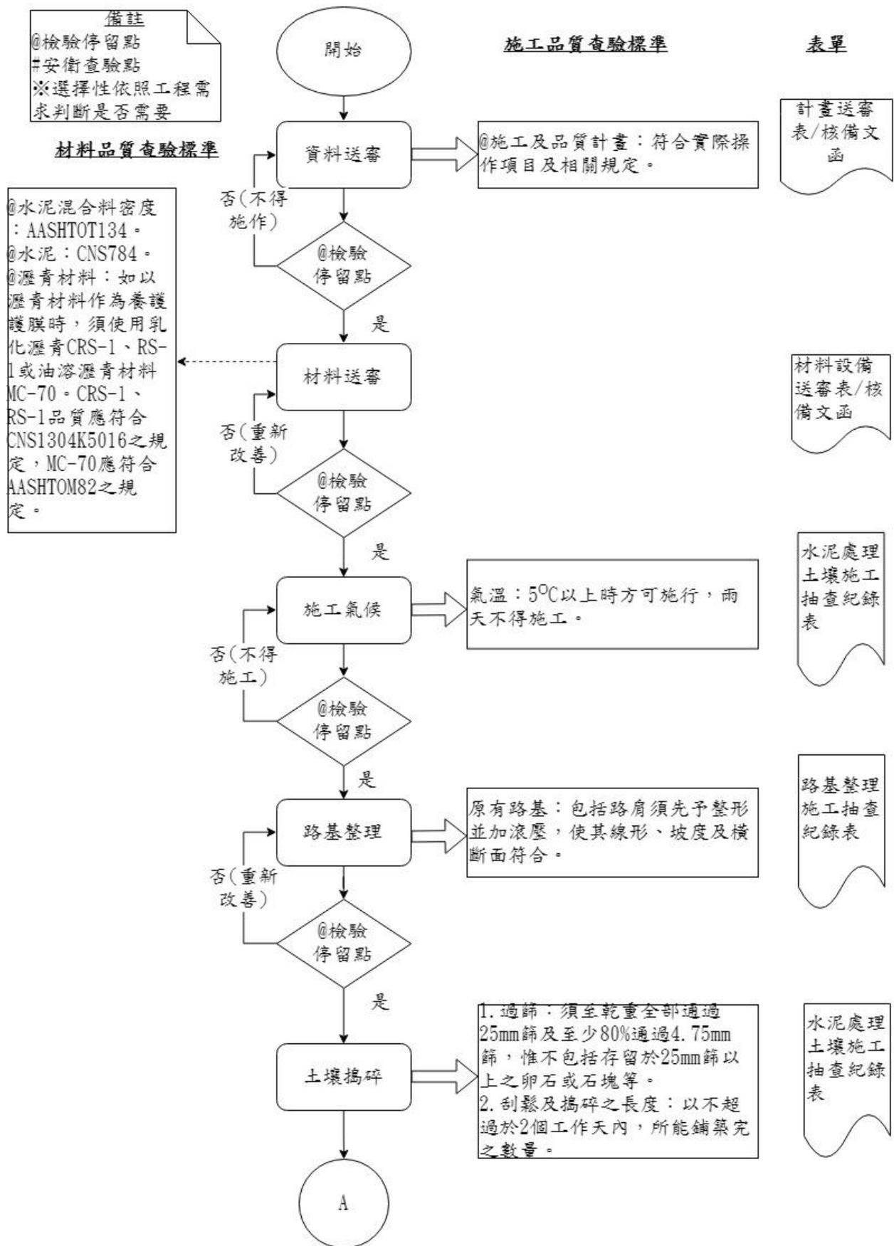
圖 027150-F-1 水泥處理土壤施工抽查流程圖 1/3
