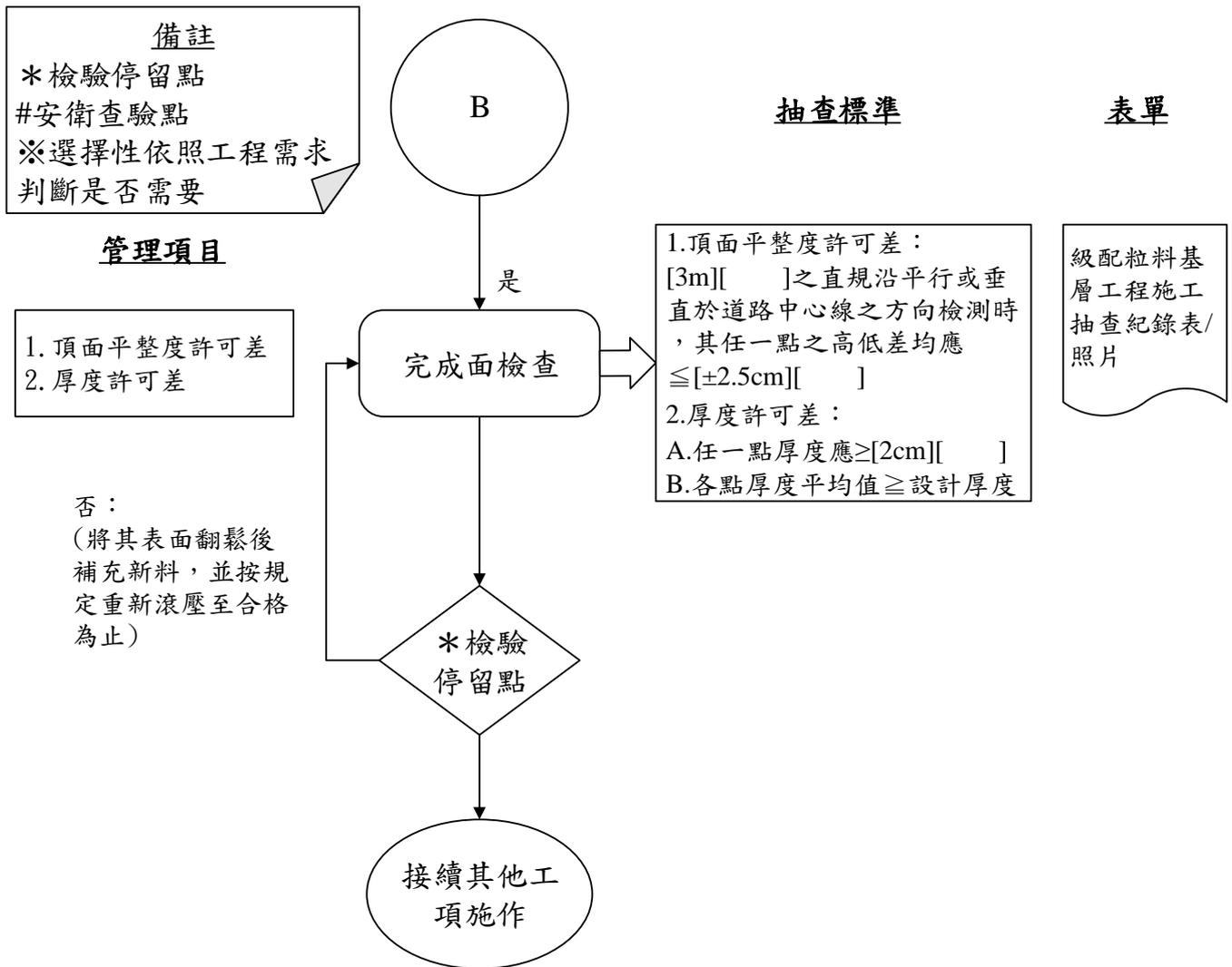
圖 027220-F-3 級配粒料基層施工抽查流程圖 3/3
