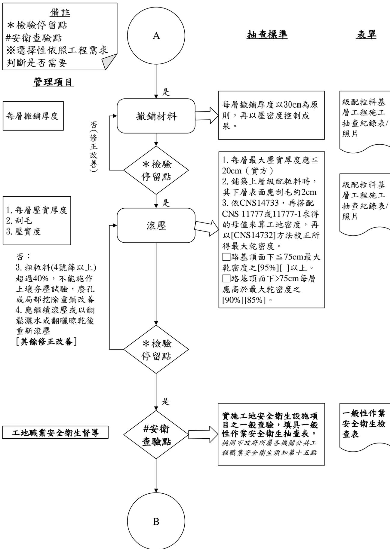
圖 027220-F-2 級配粒料基層施工抽查流程圖 2/3
