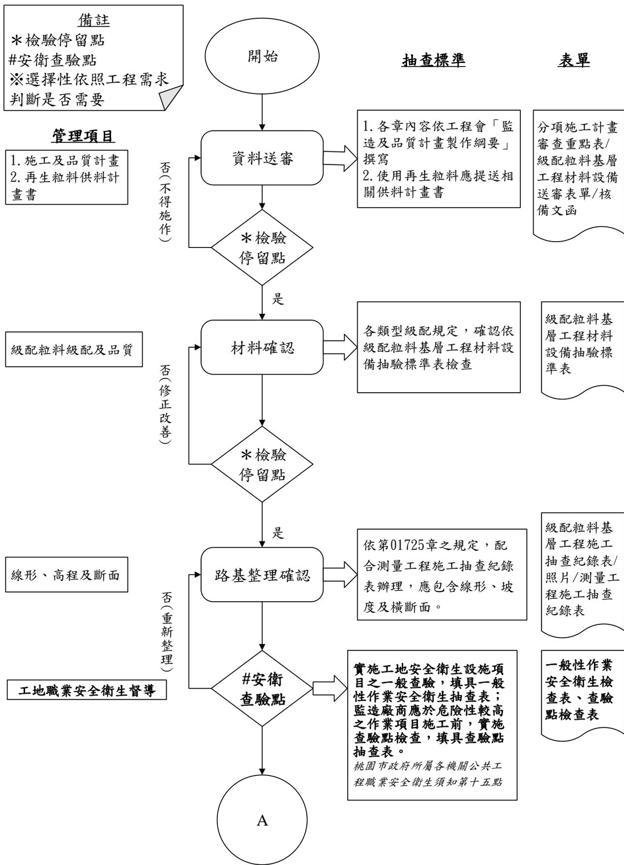
圖 027220-F-1 級配粒料基層施工抽查流程圖 1/3
