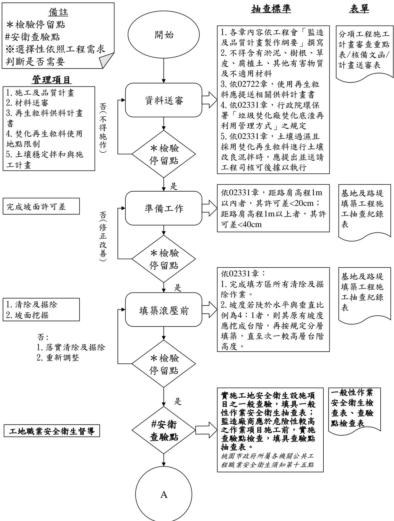
圖 023310-F-1 基地及路堤填築施工抽查流程圖 1/3
