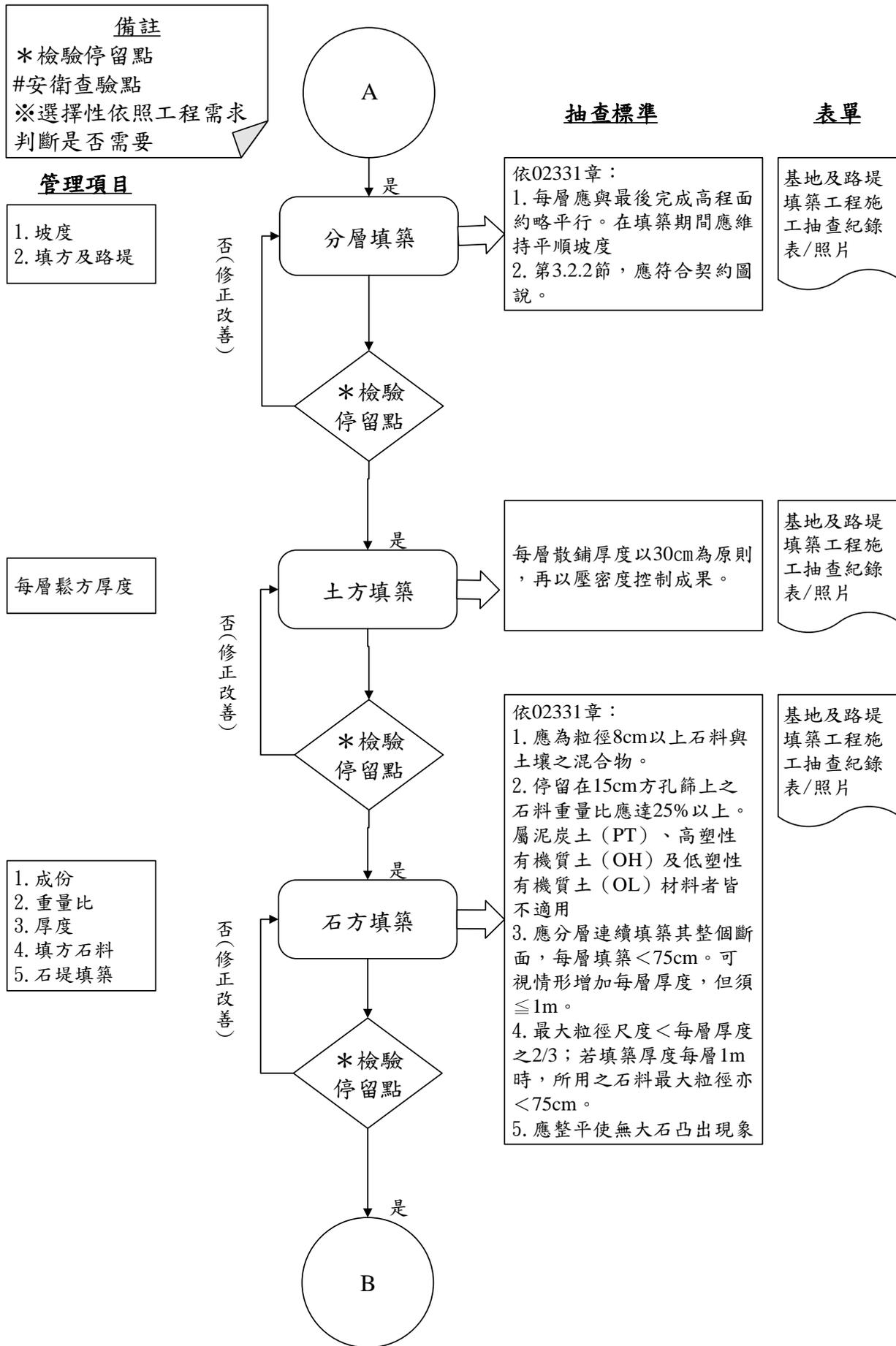
圖 023310-F-2 基地及路堤填築施工抽查流程圖 2/3
