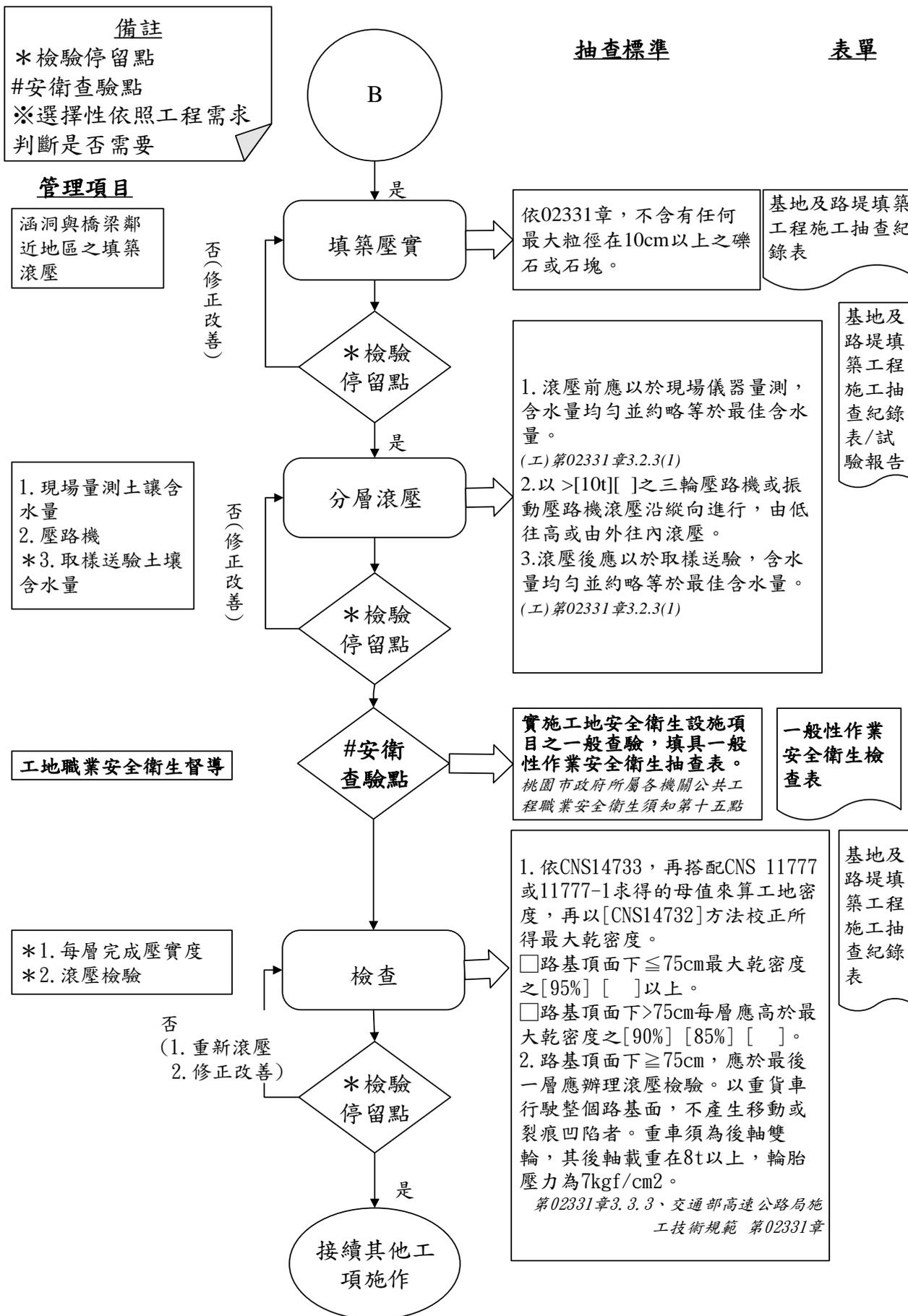
圖 023310-F-3 基地及路堤填築施工抽查流程圖 3/3
