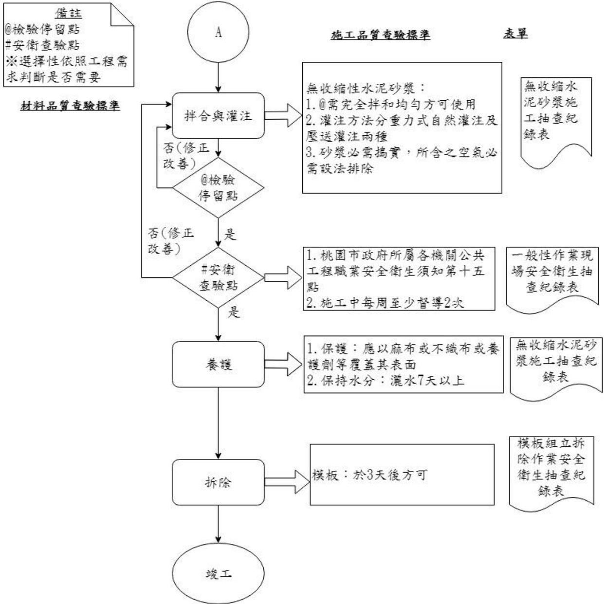
圖 036010-F-1 無收縮水泥砂漿施工抽查流程圖 2/
