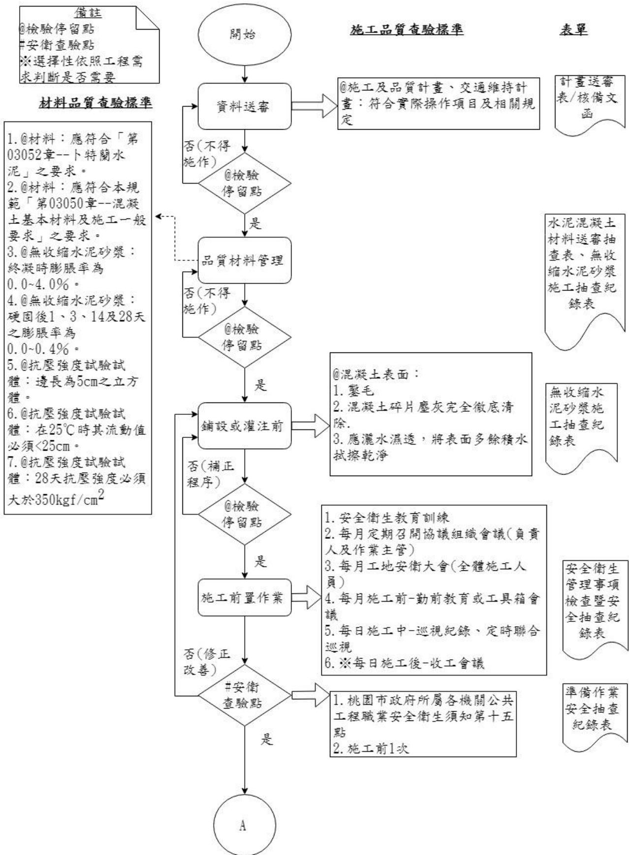
圖 036010-F-1 無收縮水泥砂漿施工抽查流程圖 1/2
