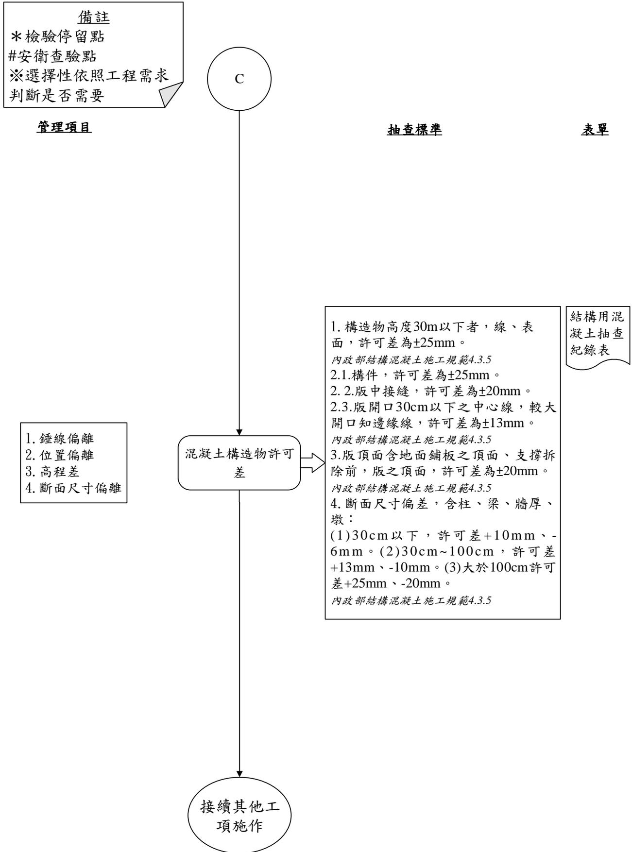
圖 033102-F- 4 結構用混凝土工程施工抽查流程圖 4/4
