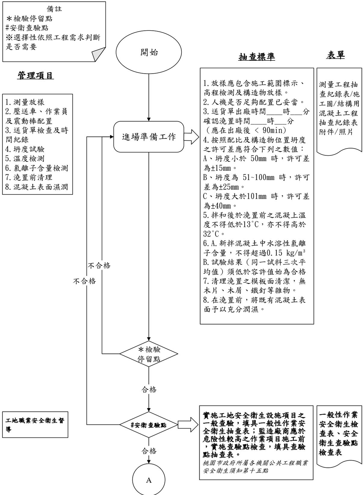
圖 033102-F- 1 結構用混凝土工程施工抽查流程圖 1/4
