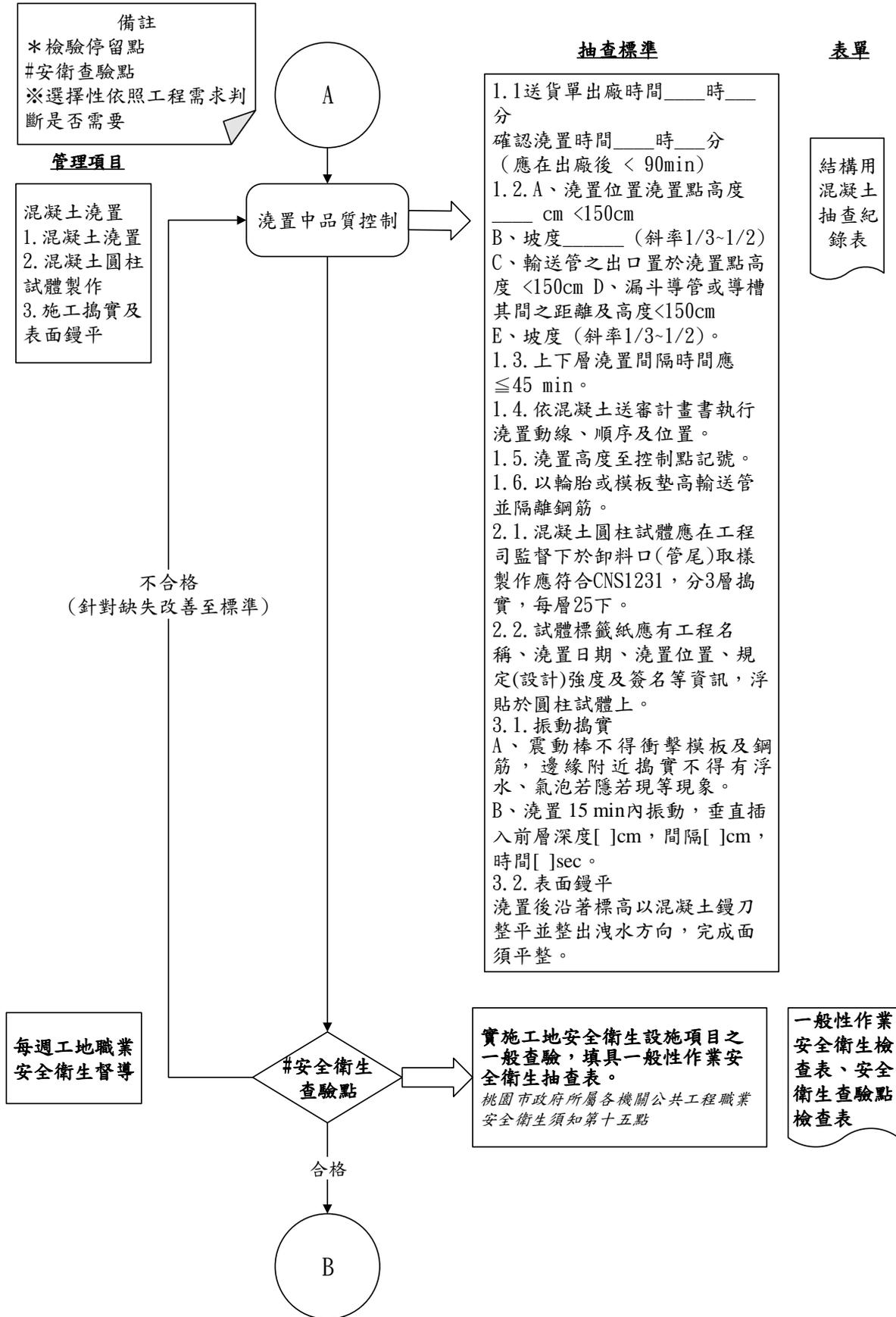
圖 033102-F- 2 結構用混凝土工程施工抽查流程圖 2/4
