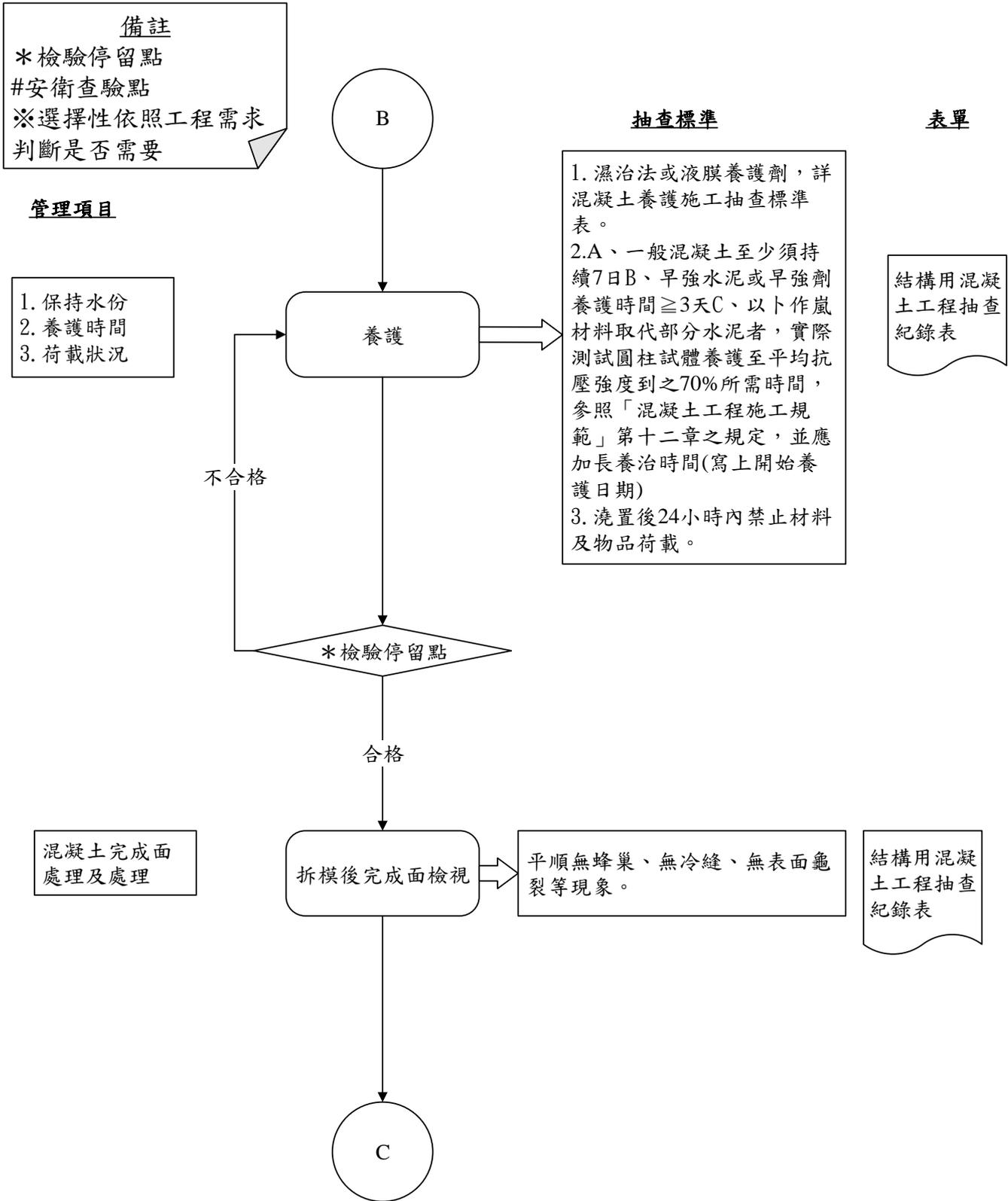
圖 033102-F- 3 結構用混凝土工程施工抽查流程圖 3/4
