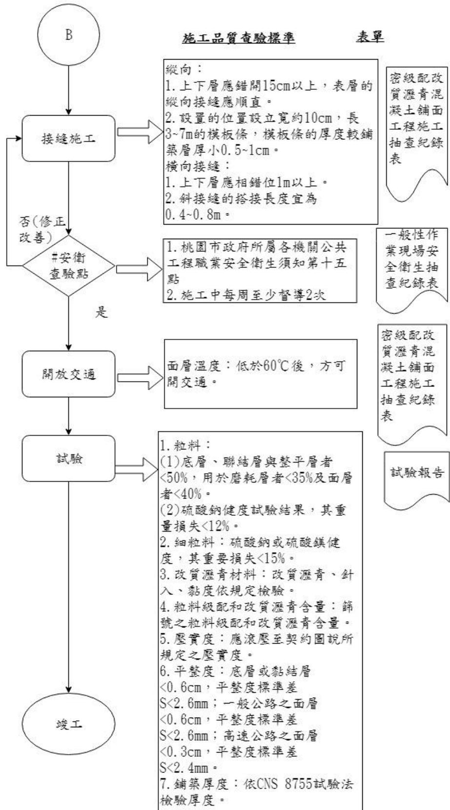
圖 027960-F-1 密級配改質瀝青混凝土鋪面工程施工抽查流程圖 3/3
