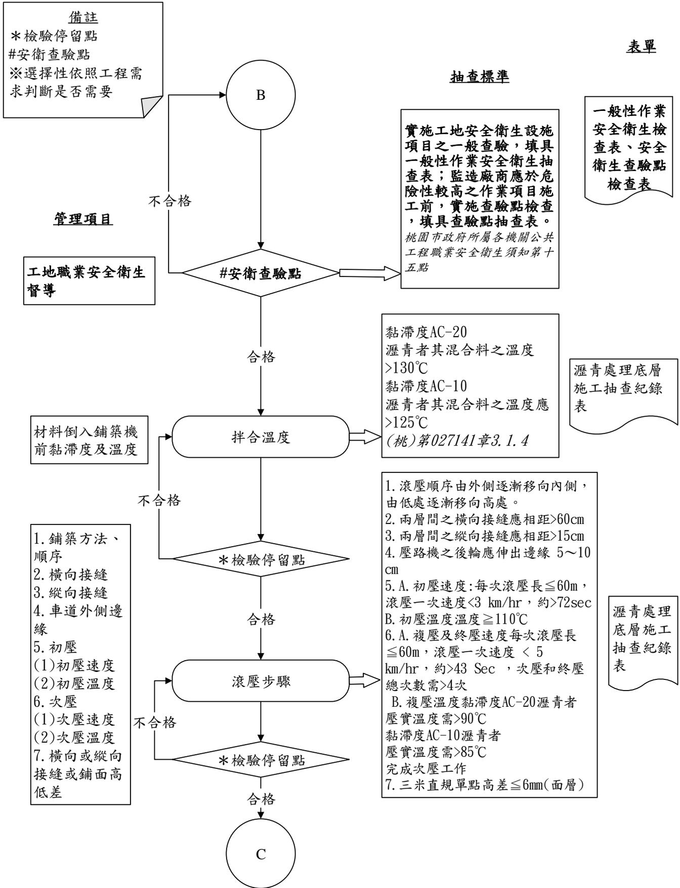
圖 027142-F-1 瀝青處理底層施工抽查流程圖 3/4
