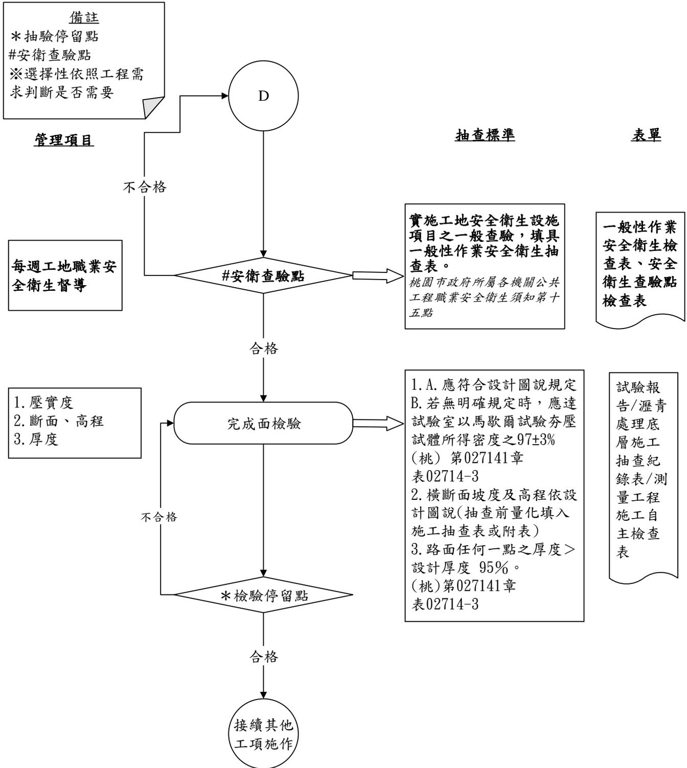
圖 027142-F-1 瀝青處理底層施工抽查流程圖 4/4
