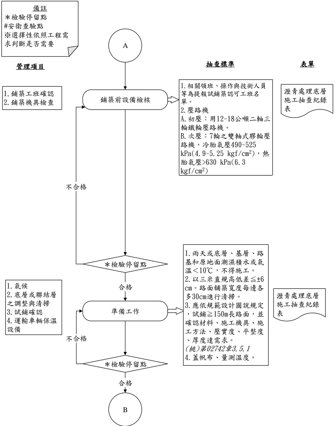
圖 027142-F-1 瀝青處理底層施工抽查流程圖 2/4
