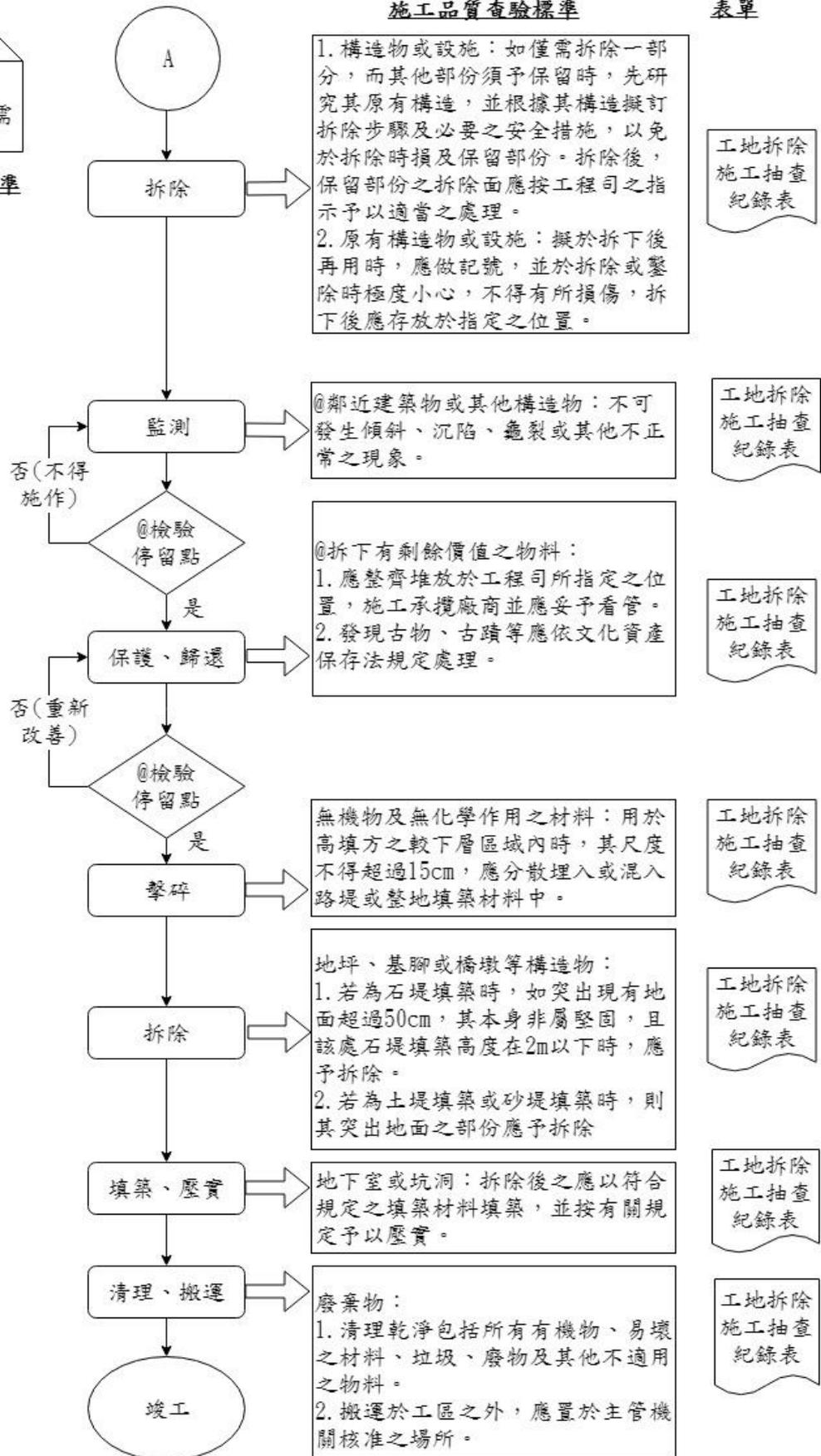
圖 022200-F-1 工地拆除施工抽查流程圖 2/2
