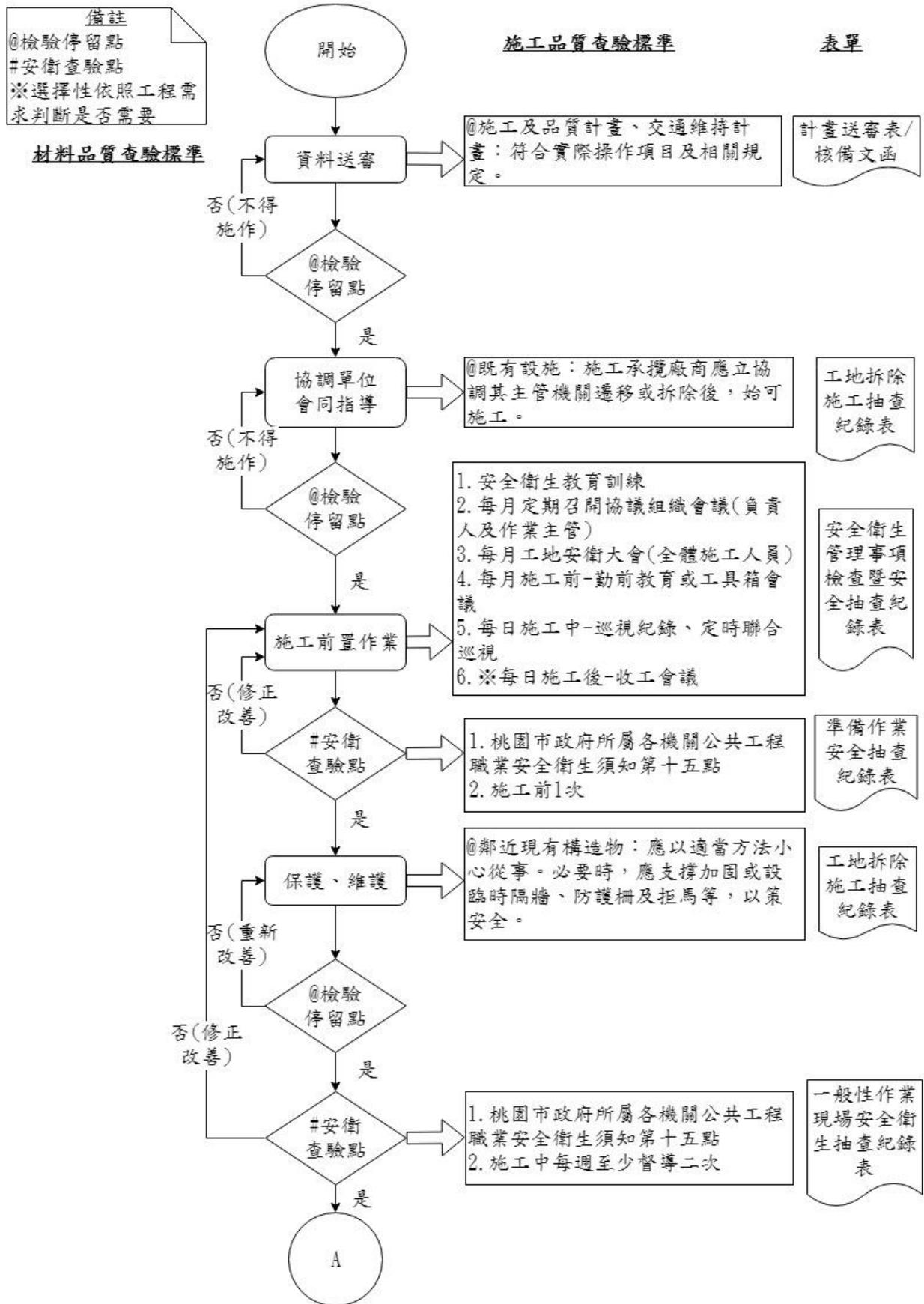
圖 022200-F-1 工地拆除施工抽查流程圖 1/2
