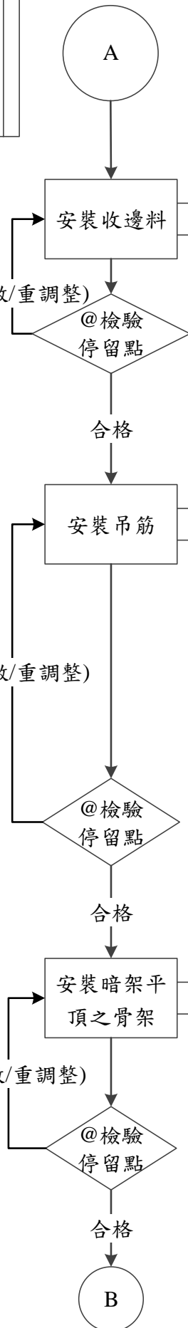
圖 095811-F-1 天花板-暗架工程施工抽查流程圖 2/3
