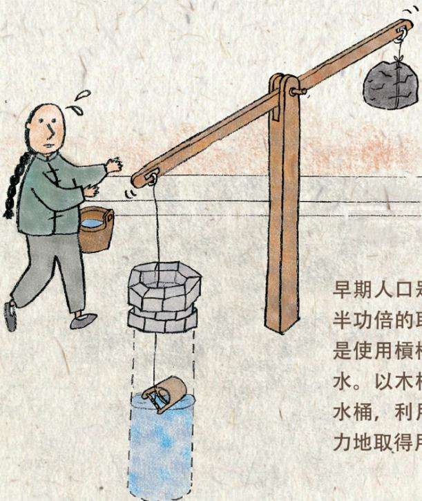
早期人口眾多的李宅，為了能事半功倍的取水來供眾人使用，於是使用槓桿原理的打水方式來取水。以木柱為支點，於端點吊掛水桶，利用槓桿的平衡，快速省力地取得用水。
