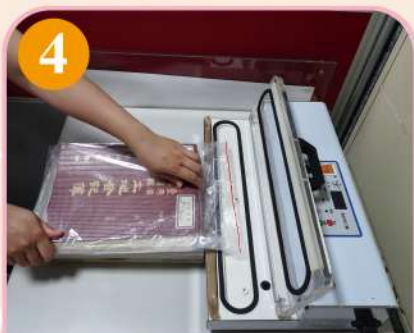
4 進行第二次真空封膜作業
