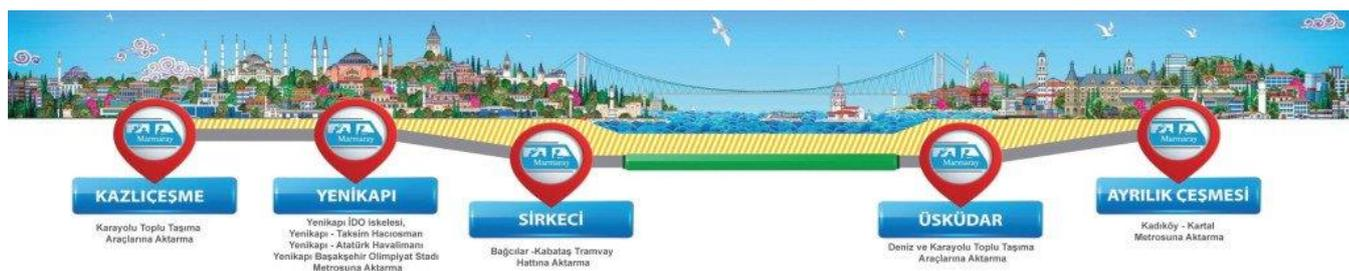
為連接伊斯坦堡亞洲和歐洲部分的鐵路海底隧道計畫，採取沉管式興建，由日本與土耳其團隊共同建設(以大成建設為首)。該工程在 2004 年 5 月 9 日動工，並於 2019 年 3 月 12 日全線通車，路線長度 76.6 公里，共 41 座車站，車輛由韓國現代樂鐵供應，號誌系統由西門子公司供應。
