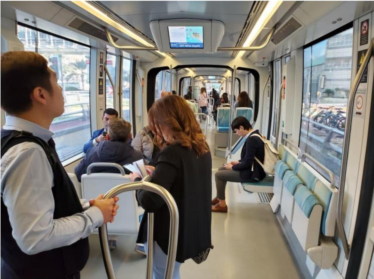
圖 25：輕軌銀卡車廂內狀況，有固定式及彈回式座位
