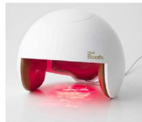
以 TO 雷射元件設計的生髮帽 ：體積大、厚重
