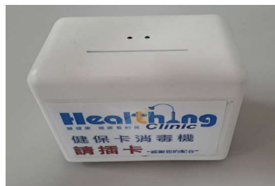
▲ 原型機二號外觀，驗證使用者設計需求，送第三方驗證機構，進行滅菌有效性測試
