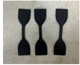
▲ 防水塗料成品製備成啞鈴狀試片
