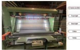
▲ 智慧化織物瑕疵影像辨識技術結合人工智慧於壓光織物動態瑕疵辨識與分類系統
