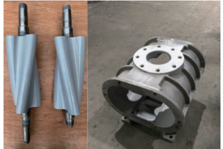
▲ 節能扭葉式鼓風機葉輪(左)、主體(右)加工後實體圖
