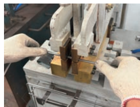
▲ 製程測試-電銲完成
