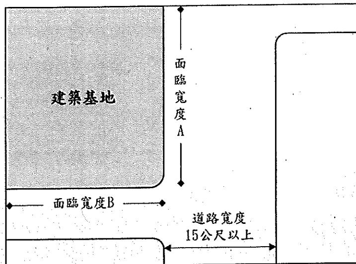
2、建築基地臨接面前道路之寬度  $A+B \geq$ 十五公尺。
