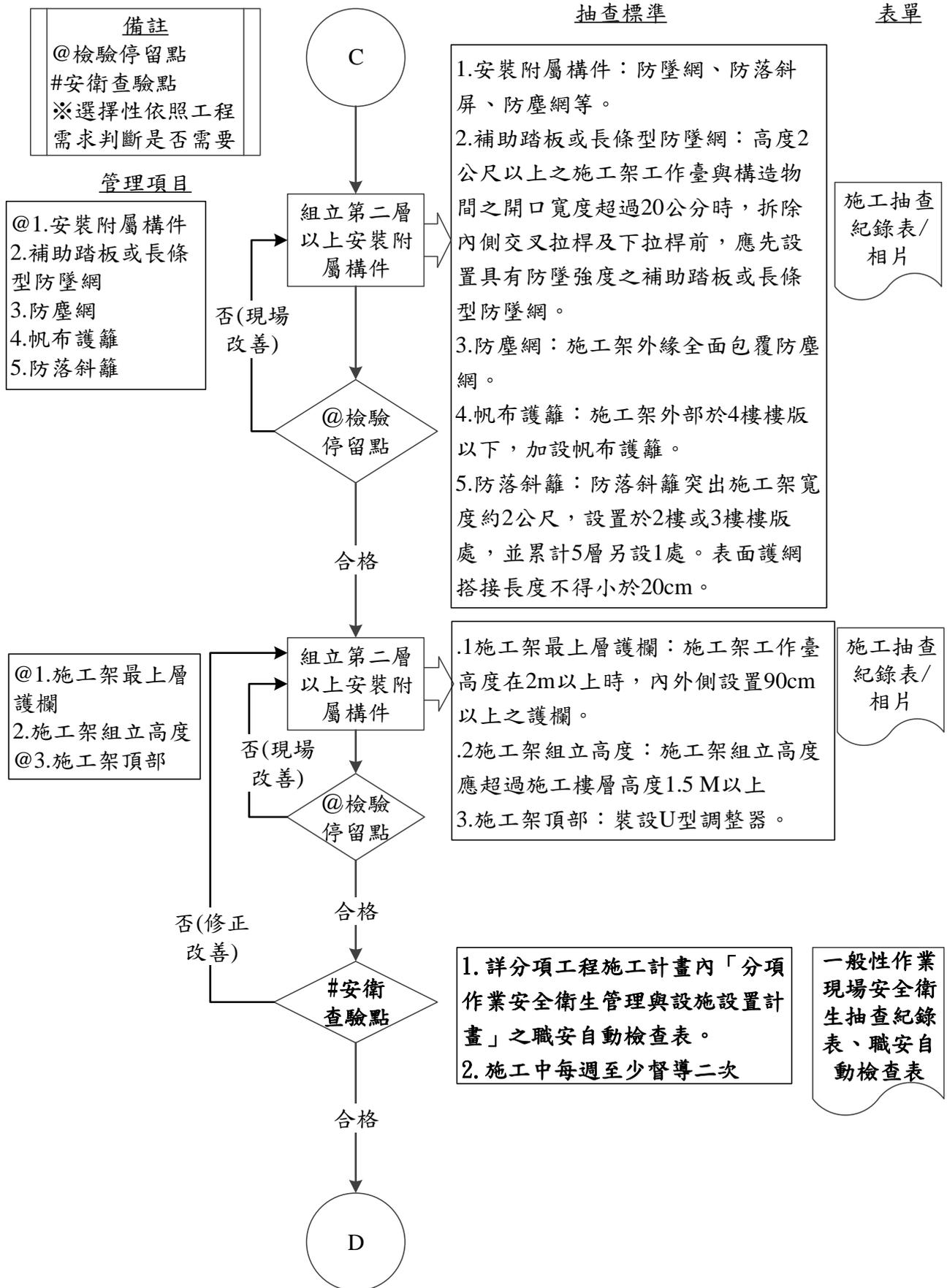
圖 015001-F-1 施工架工程施工抽查流程圖 4/5
