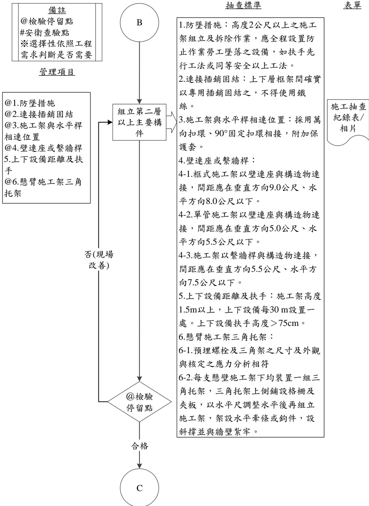
圖 015001-F-1 施工架工程施工抽查流程圖 3/5
