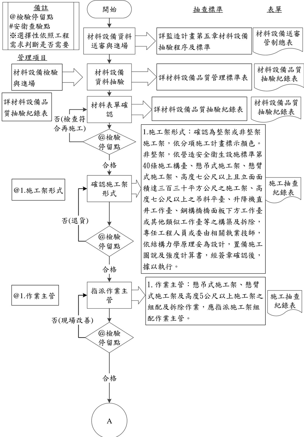
圖 015001-F-1 施工架工程施工抽查流程圖 1/5
