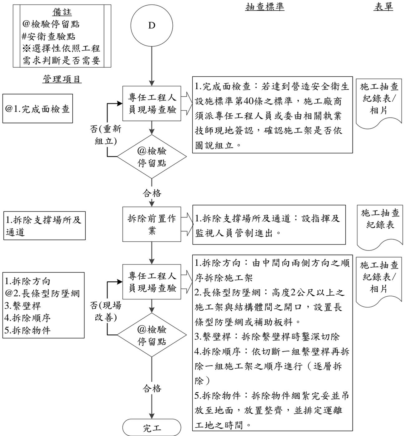
圖 015001-F-1 施工架工程施工抽查流程圖 5/5
