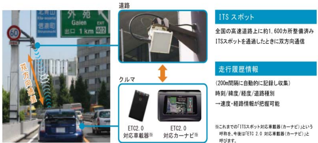
図 50 ETC2.0 服務原理
