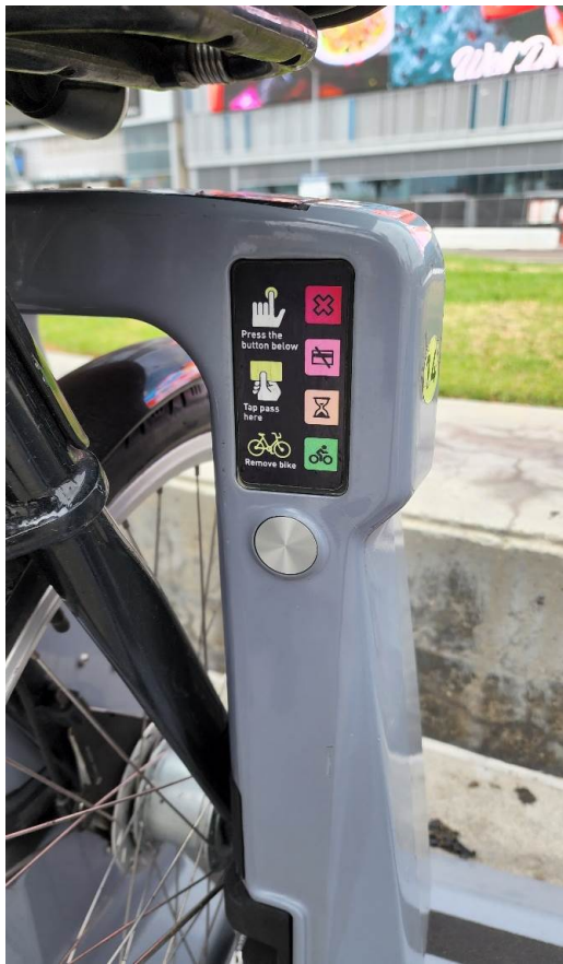
圖 43 停車柱卡榫及感應面板
