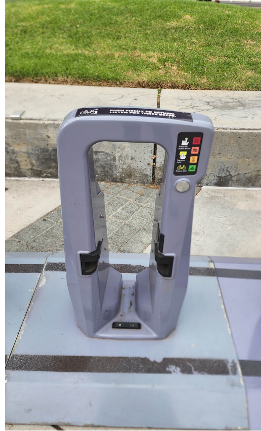
圖 43 停車柱卡榫及感應面板
