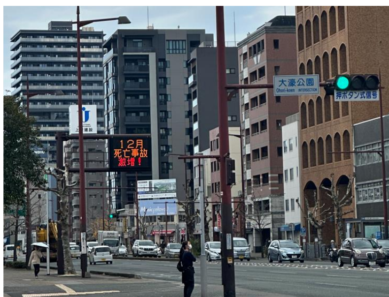
資訊可變標誌(CMS)
