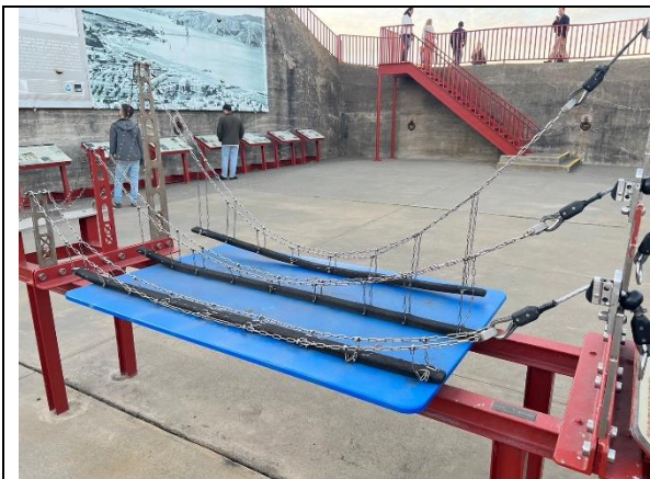
圖 73 模擬不同高度的橋塔造成拉力差別 (資料來源：團員拍攝)
