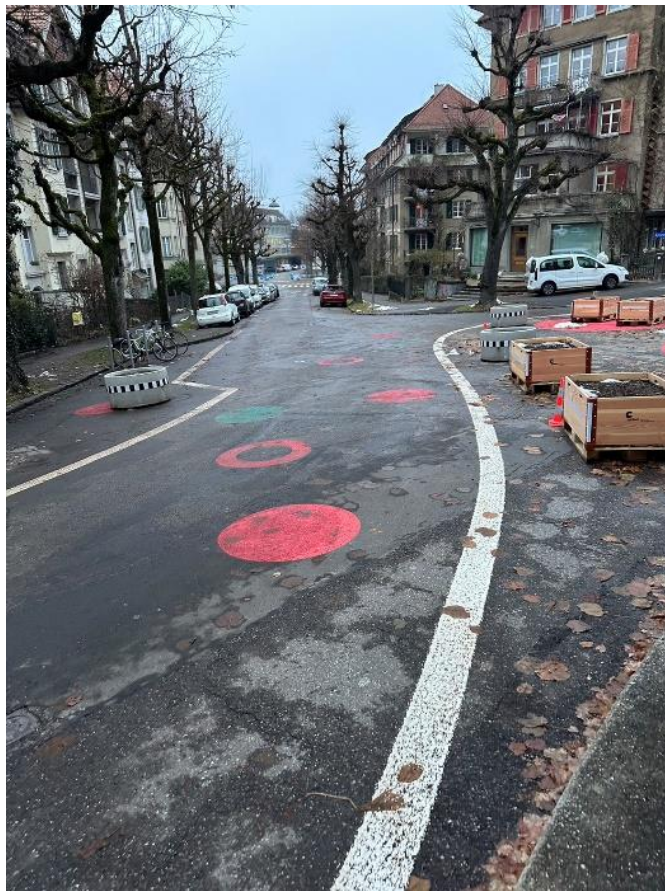
圖10 住宅區彎曲標線繪設方式
