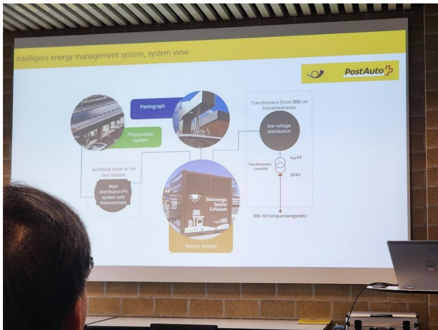
圖37 Brugg 公車總站充電站能源系統說明
