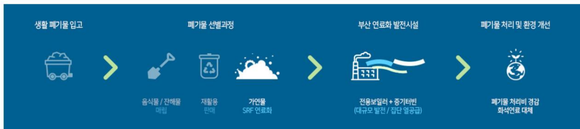
圖 4-1-1、燃料發電設施發電原理
