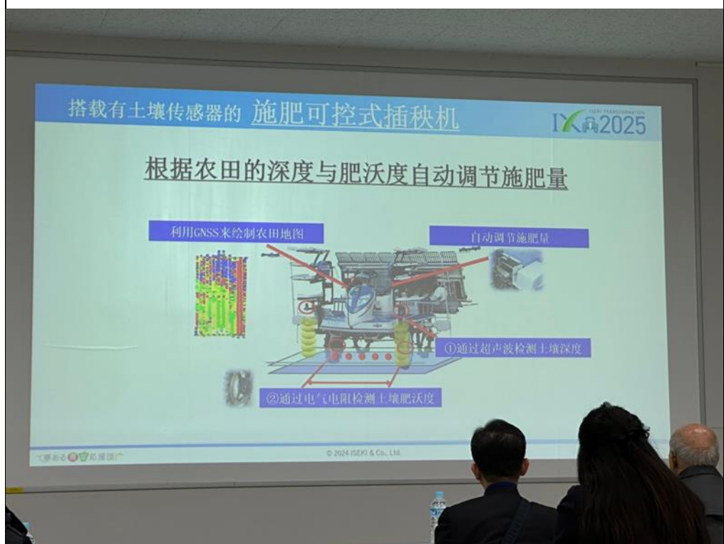
圖13簡報介紹裝設土壤監測計的可控式施肥插秧機
