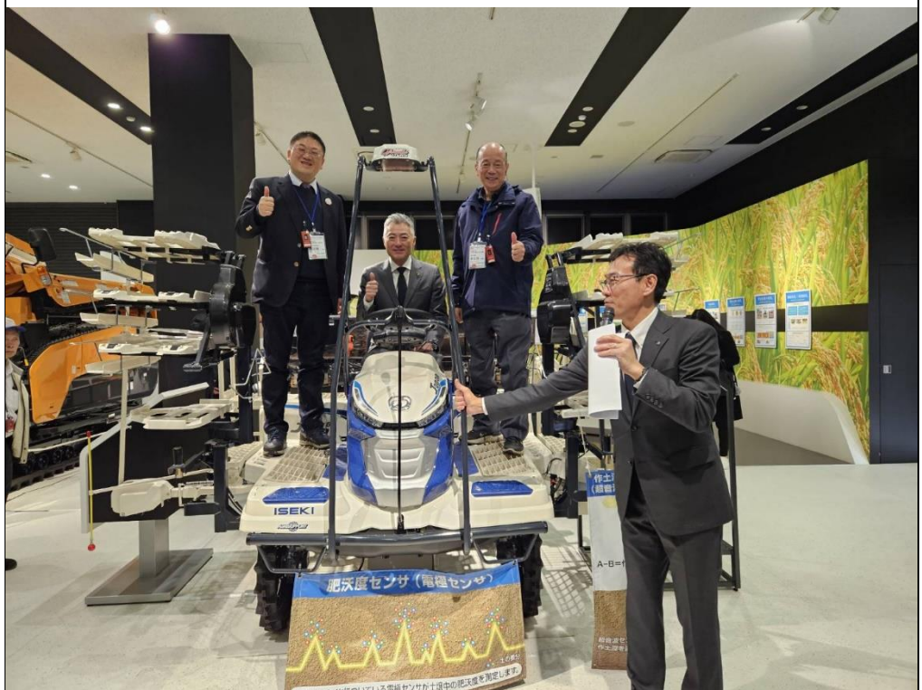
圖14裝設土壤監測計的可控式施肥插秧機
