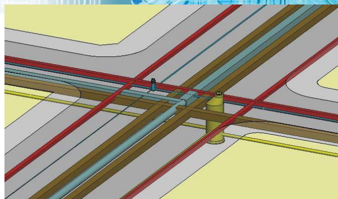
基設階段-管線衝突標示及告知
