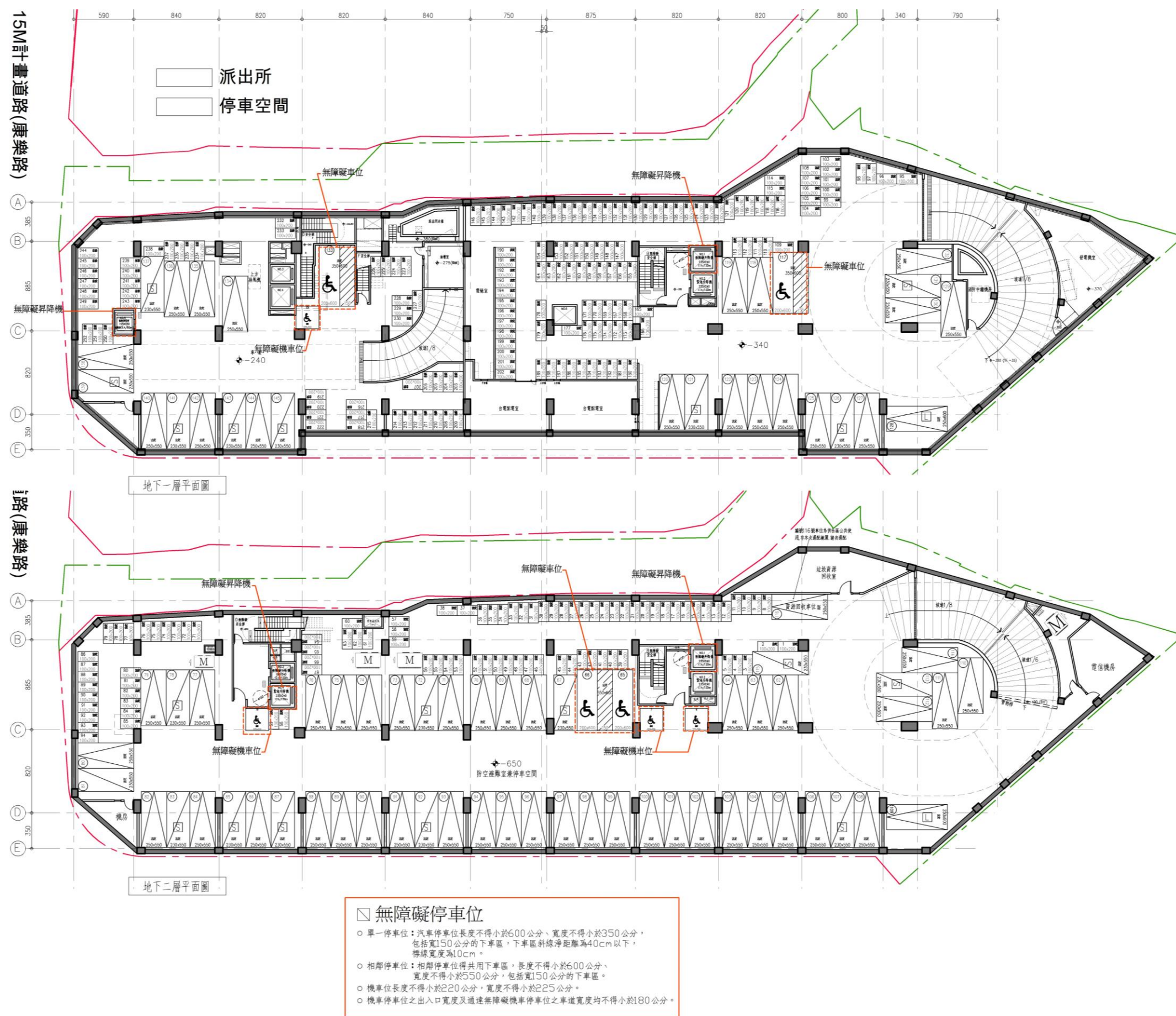
圖 11-15 無障礙空間規劃說明圖Ⅲ(比例尺：1/400)
