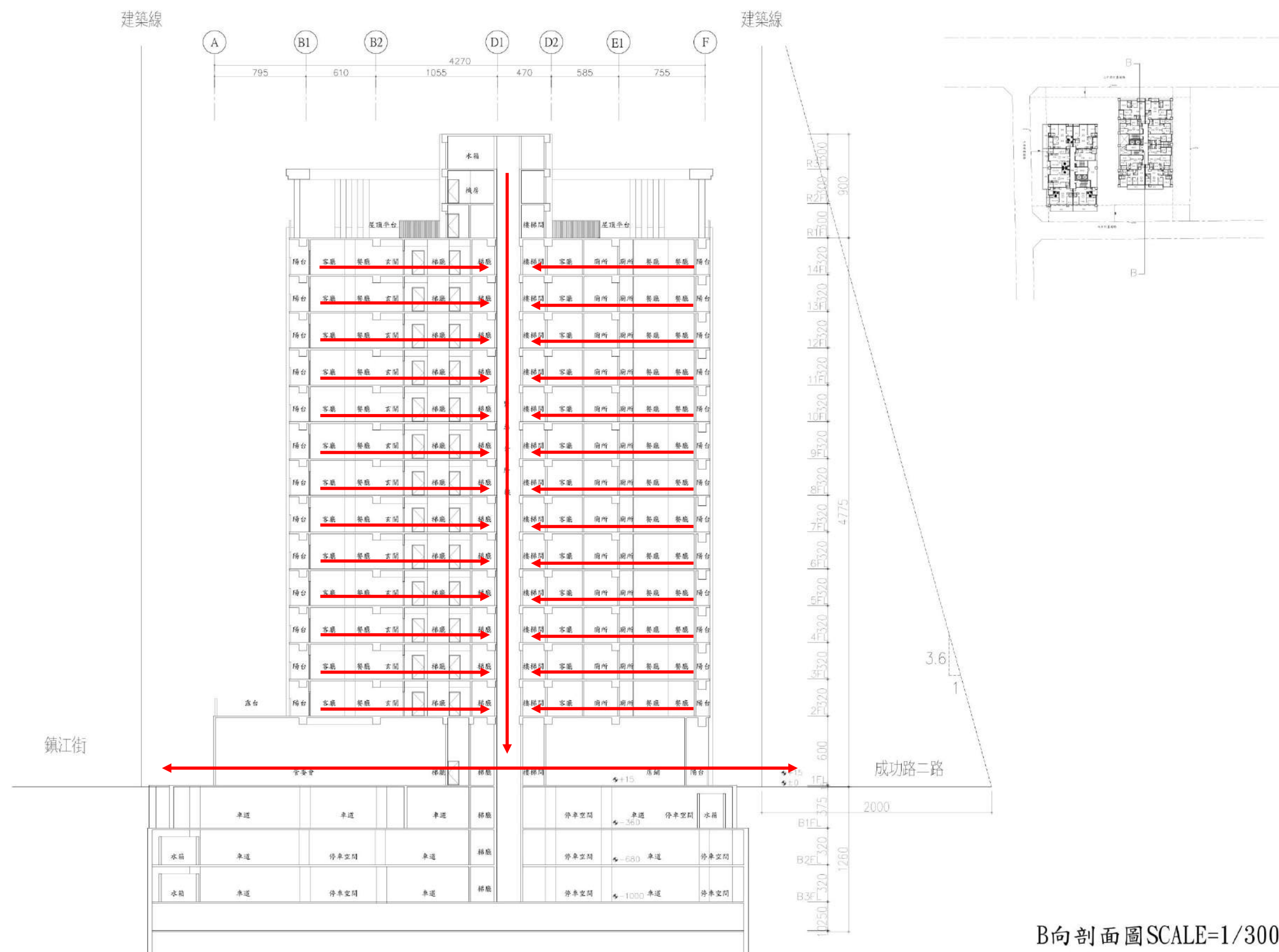
圖 10-34 防災避難動線剖面示意圖 (S:1/300)
