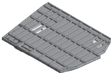
筏基+地梁混凝土澆置
