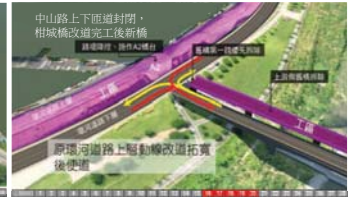
◆ 第二階段2-1項：拆除舊橋橋台、降挖路堤、施作A2橋台
