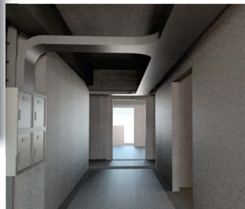
採用密閉性線槽配置管線
