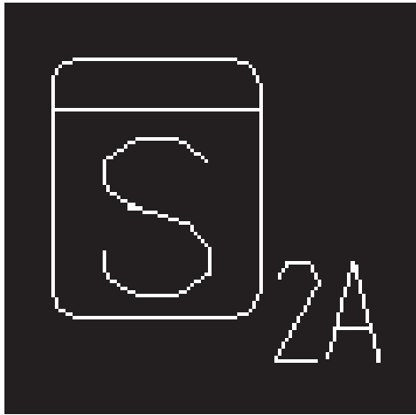
火警探測器3DBIM模型轉換2D標準圖例示意
