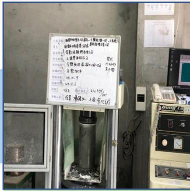
混凝土抗壓試驗
