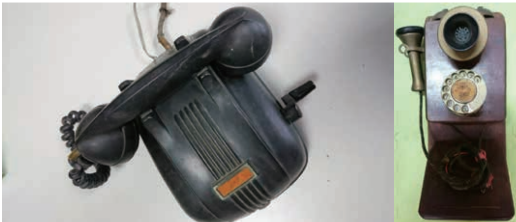
圖 3：手動式磁石電話與（左）與 1930 年代脈衝式步進制自動撥號轉盤電話（右）。
