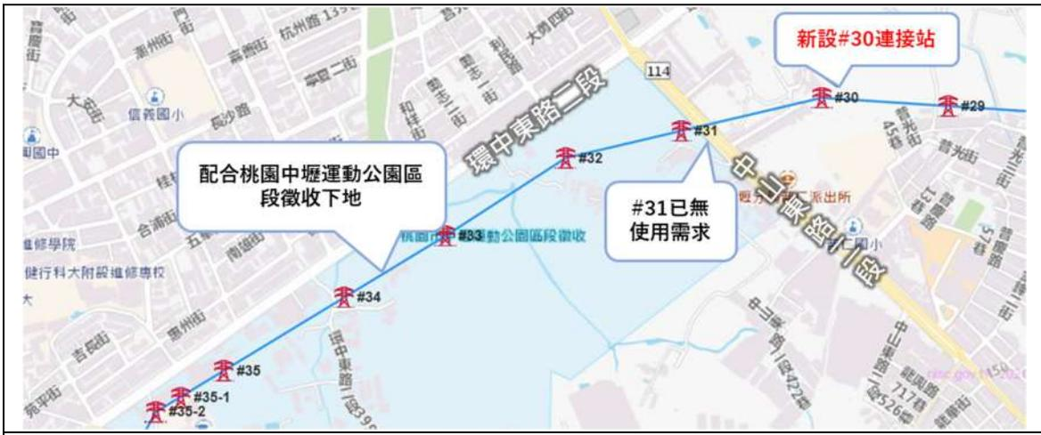
圖 5 高壓電塔管線下地工程路線示意圖
