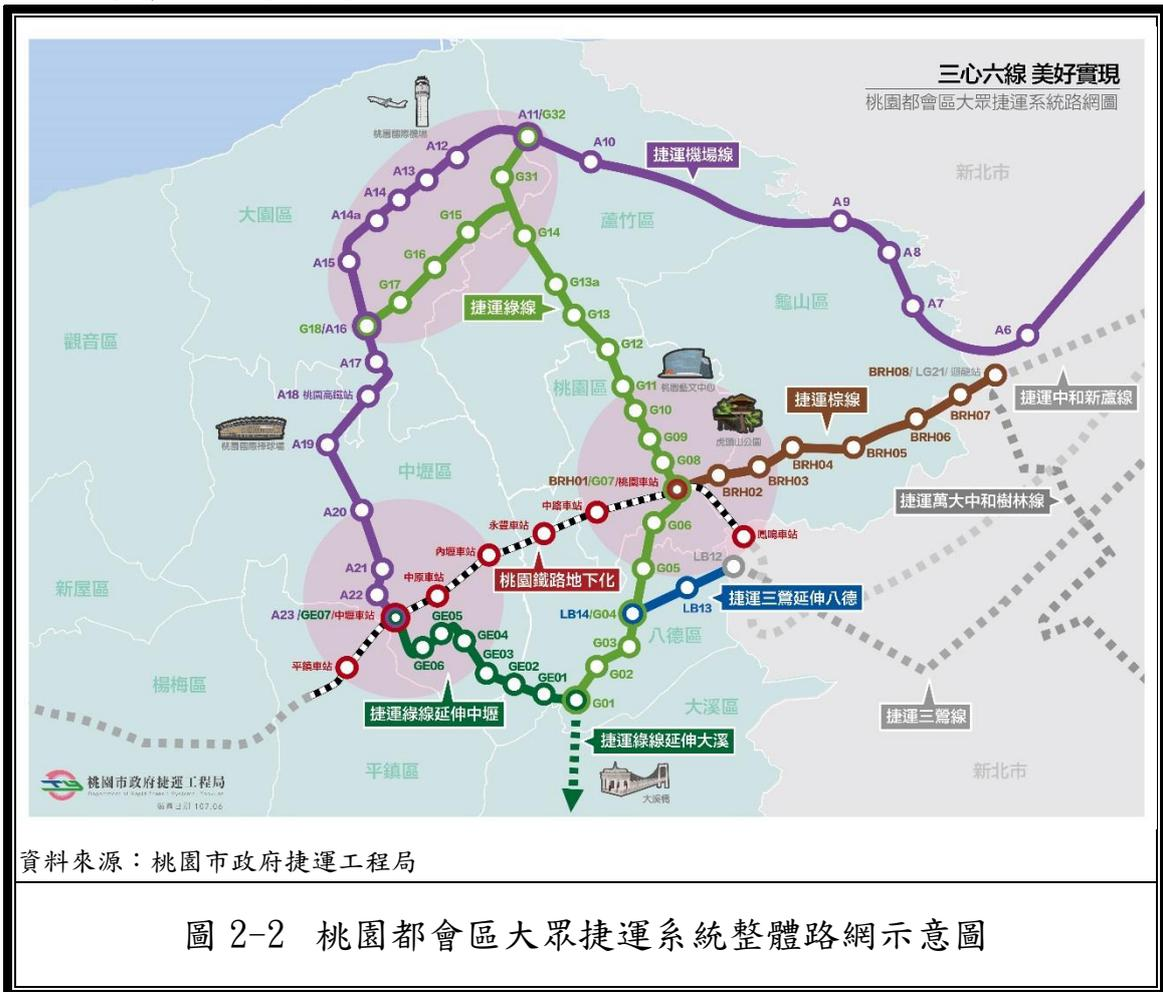
該計畫範圍起自新北市鶯歌區鳳鳴陸橋北側，南至桃園市楊梅區埔心車站南側，將原高架化路段及車站改採地下形式構築，除鳳鳴車站與原高架化計畫相同外，地下化車站包含桃園、內壢、中壢等 3 座既有車站，以及中路、桃園醫院、中原、平鎮等 4 處新增車站，路廊全長約 17.95 公里。工程完工後可消除平交道 20 處、陸橋 8 處、地下道 8 處，改善交通瓶頸及行車安全問題，增加旅客搭乘鐵路之可及性，並促進都市機能縫合及地方發展。
