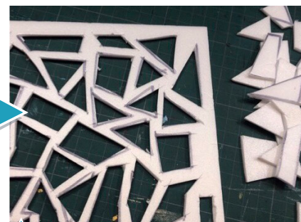
▲14. 將路線外的部分切除鑲空，要注意切割時維持板面的強度。
