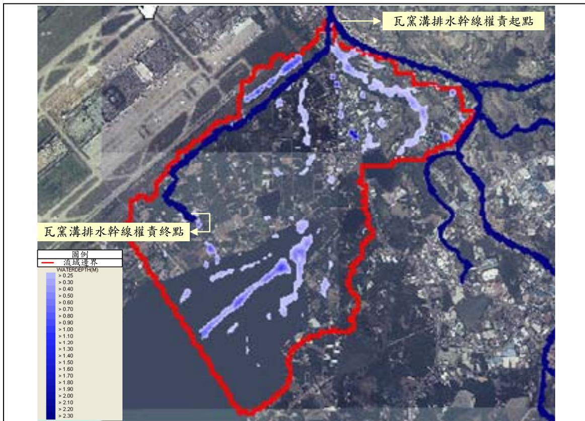
圖 5-13 瓦窯溝排水現況 Q<sub>10</sub> 洪水位淹水潛勢範圍圖
