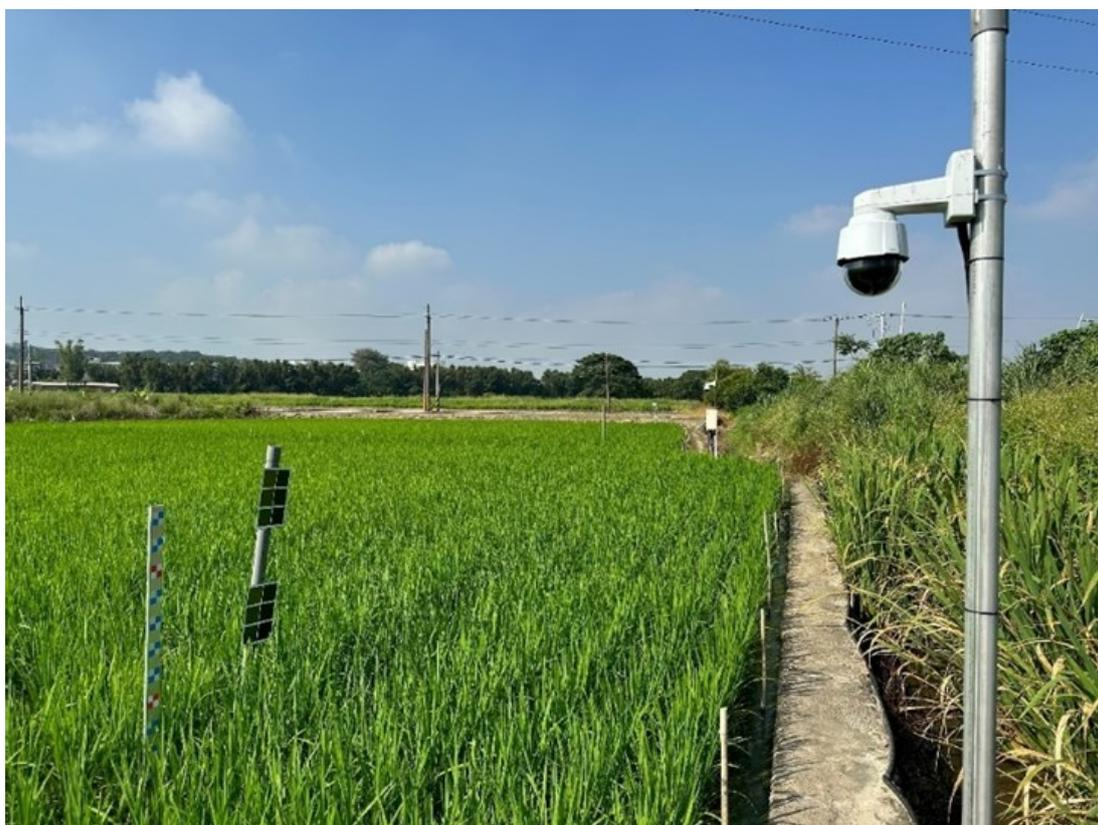
圖 4. 楊梅水資中心回收放流水農灌試驗及 AI 辨識系統
