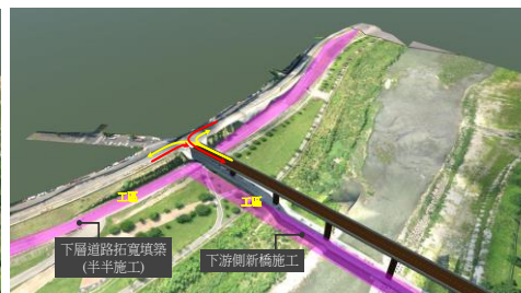
◆ 第一階段1-2~1-3項：施築改道便道（下層道路拓寬）
