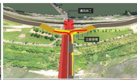
◆ 第三階段：施築新橋上游側邊跨、交維便橋改道
