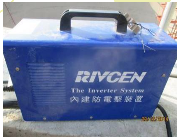
工區內電焊機皆自動電擊防止裝置
