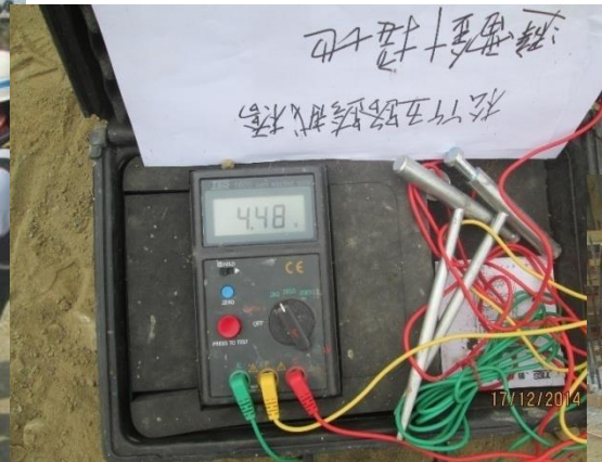
埋設接地銅棒，電阻測試，達標準5歐姆以下
