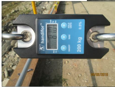
安全護欄定期拉力測試，達標準75kg以上
