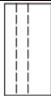
柱狀破壞 (E)
