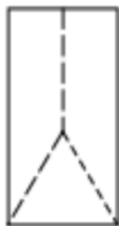
錐形兼劈 裂破壞 (B)
