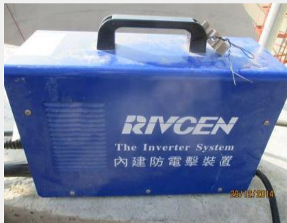
工區內電焊機皆自動電擊防止裝置
