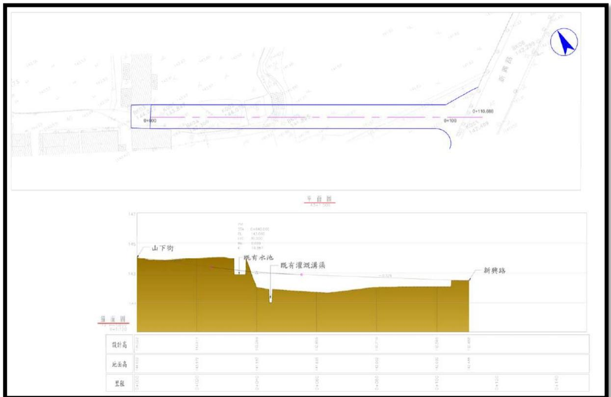
本計畫新闢道路預計拓寬為 8 公尺寬，與既有山下街尾端寬度一致，配置雙向 3.5 公尺混和車道，於靠近國小側增設 1 公尺人行道，標準斷面配置圖詳圖。
